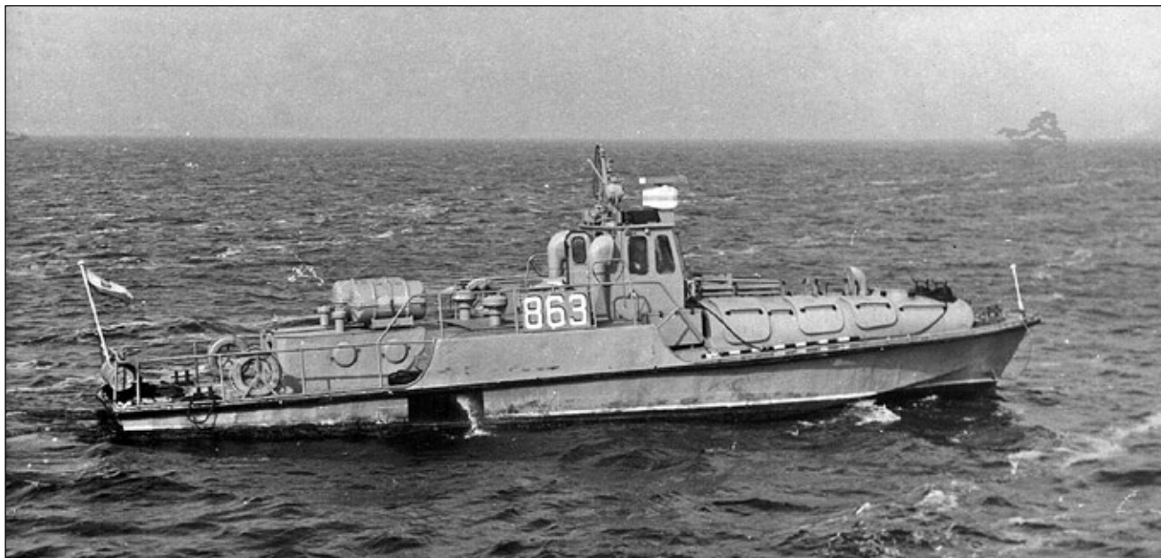
W latach 1962 -1964 Marynarka Wojenna wzbogaciła się o nowe kutry desantowe proj. 709. Wybudowane w liczbie 15 w Stoczni Marynarki Wojennej w Gdyni stanowiły sprzęt dywizjonu kutrów desantowych. Na fotografii jednostka po modernizacji polegającej na zabudowie ładowni i przesunięciu sterówki na śródkręcie.
