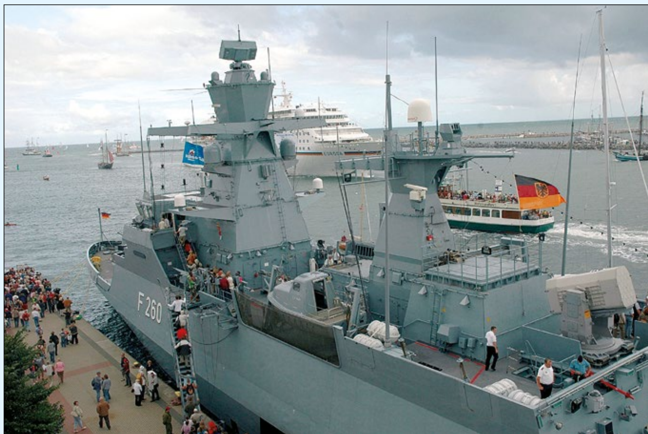
I ostatnie, bardzo ciekawe ujęcie Braunschweig . Dobrze widoczna rufowa wyrzutnia rakiet RAM oraz bardzo rozbudowana elektronika na obu masztach. Fot. Reinhard Kramer
