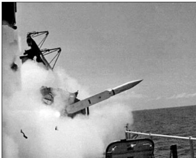
Moment wystrzelenia pocisku raketowego Mk 15 „Tartar” z lewoburtowej z rufowej wyrzutni krążownika Chicago (CG-11). Fot. U.S. Navy
