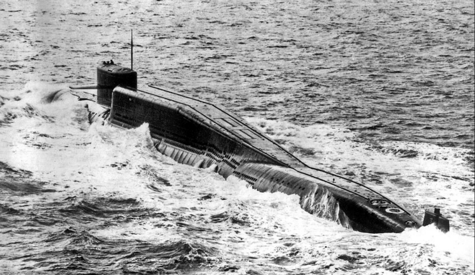
Bardzo ciekawe ujęcie jednego z okrętów. Na skosie garbu widoczne dwie pokrywy anten VLF.
