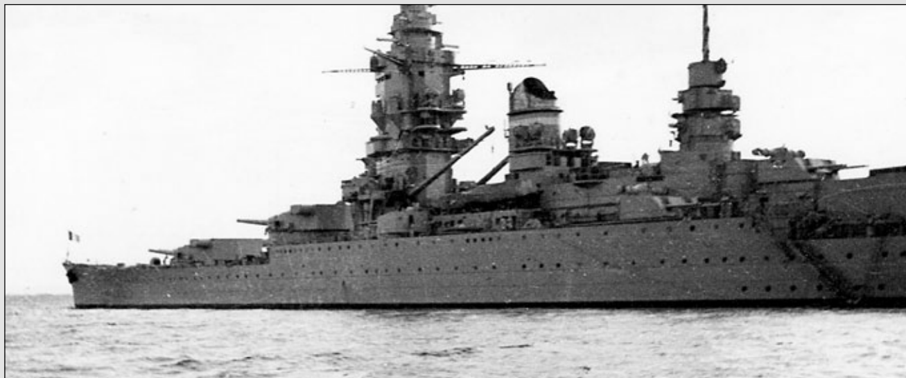
To ujęcie Dunkerque dobrze ukazuje rozmieszczenie wież dwu i czterolufowych dział kal. 130 mm. Widoczny jest też rufowy pomost z dalmierzami. Fot. zbiory Jarosław Malinowski
