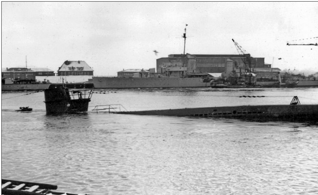
Wynurający się z próbnego zanurzenia okręt typu VIIC. Fotografię wykonano prawdopodobnie w basenie stoczniovym w Kilonii.
