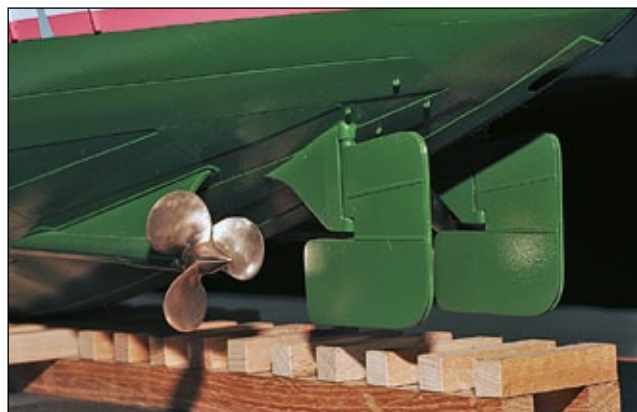
Lewoburtowa śruba napędowa z jej piórami;
