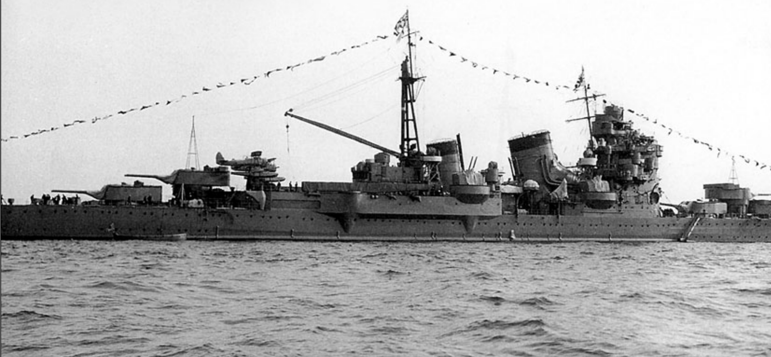
Ashigara w Kilonii - 14.05.1937 r. Dobrze widoczne śródkręcie i brak rufowych wyrzutni torped.
