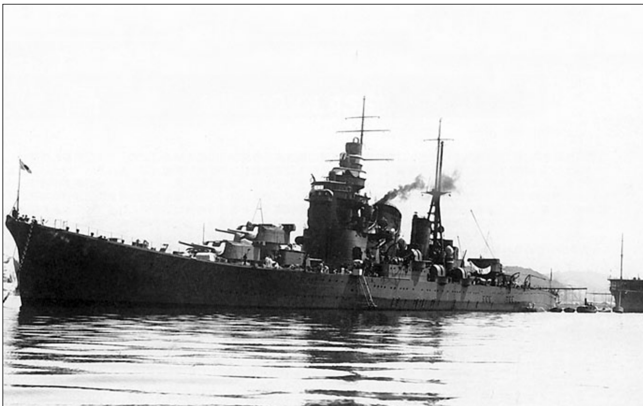
Nachi w 1929 r. Wygląd po opuszczeniu stoczni z pojedynczymi działami kal. 120 mm ulokowanymi schodkowo. Jednostka jest już po dodaniu dodatkowego pokładu wokół dziobowego komina.
