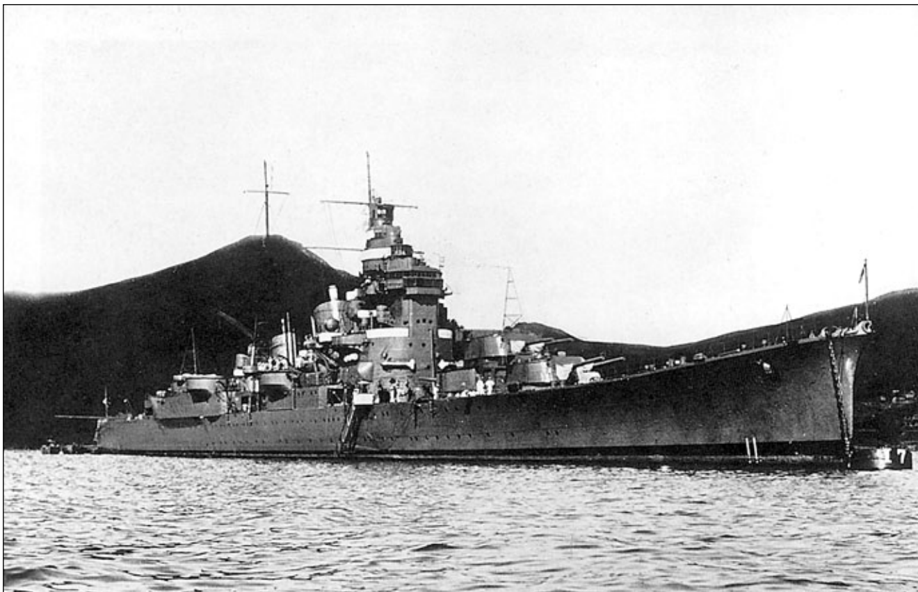
Haguro po ukończeniu. Na ścianach dziobowej nadbudówki ulokowano pływaki trału kontaktowego. Fot. „Ships of the World”
