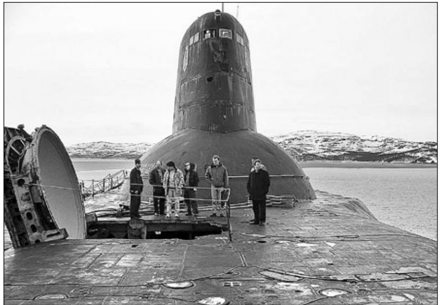
Otwarta masywna pokrywa jednej z wyrzutni rakiet R-39.
