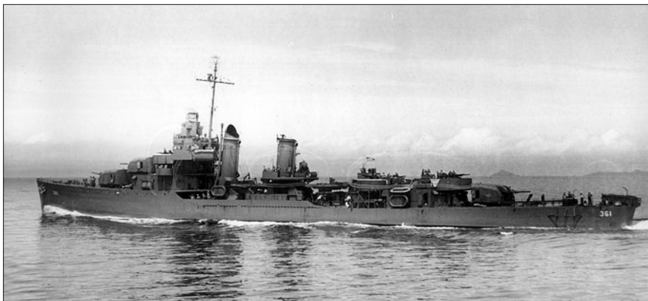
Niszczyciel Clark sfotografowany w dniu 26 maja 1942 roku w strefie Kanału Panamskiego. Trzecia wieża dział 127 mm została już z okrętu zdemontowana. Fot. zbiory Arthur D. Baker III
