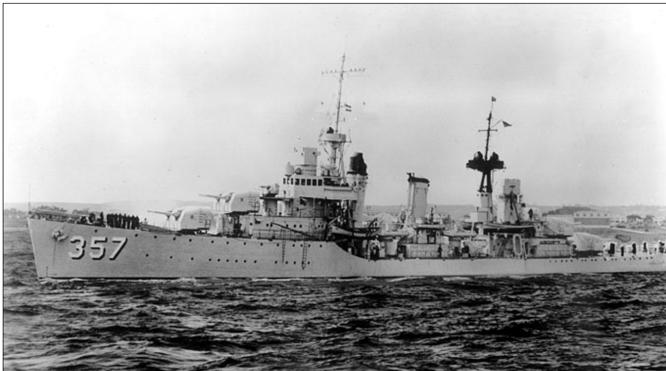
Niszczyciel Selfridge w pierwotnej konfiguracji. Na pierwszym kominie widoczna dodana osłona mająca zapobiegać zadymianiu pomostu dla reflektorów na maszcie głównym. Fotografia z 1941 roku. Fot. zbiory Arthur D. Baker III
