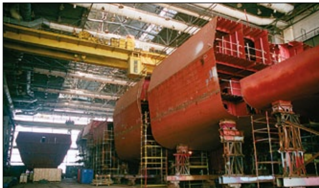
Sekcje kadłuba korwety projektu „Gawron” przygotowane do zespawania. Fot. Wojciech Łuczak
