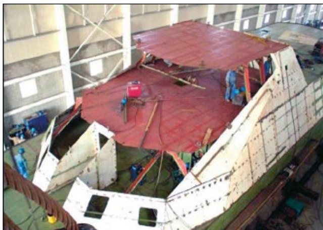
Widok na montaż poszczególnych sekcji kadłuba „PAF III” w hali stoczni Cotecmar w Kartagenie.
