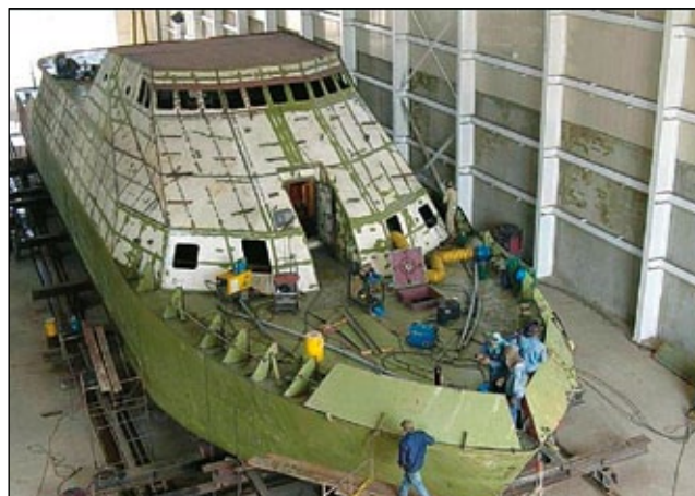
Widok na montaż poszczególnych sekcji kadłuba „PAF III” w hali stoczni Cotecmar w Kartagenie.
