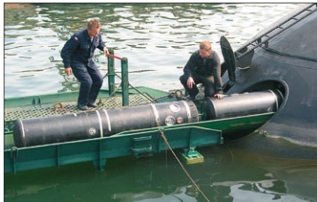
Prototyp nowej polskiejminy dennej o cechach podwodnego Stealth – efekt programu „Sikora” Akademii Marynarki Wojennej i CTM – wędruje do wyrzutni torpedowej okrętu podwodnego Orzeł .
