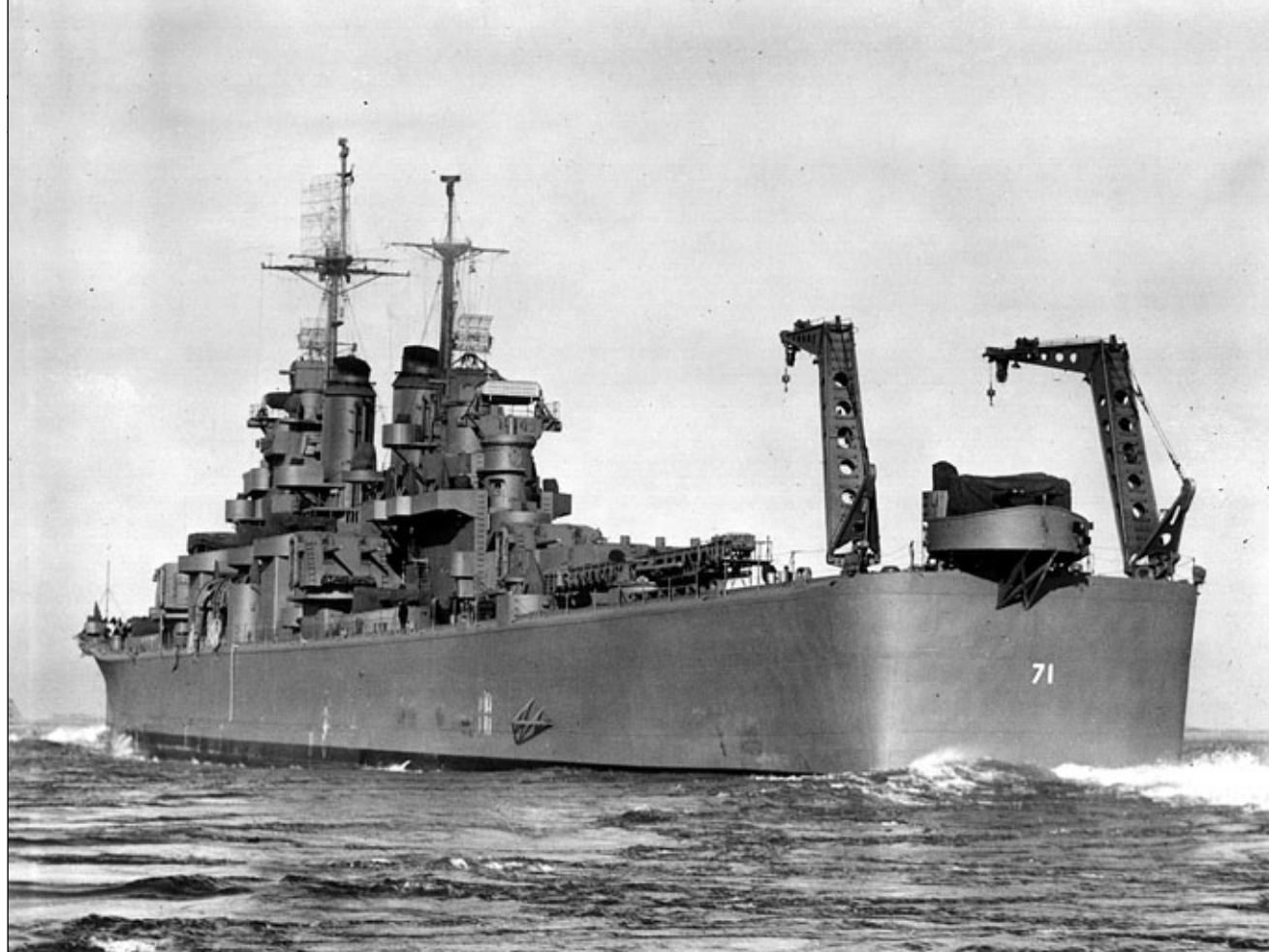
Wyposażenie radiolokacyjne pierwszej serii krążowników typu Baltimore , stanowiły stacje dozoru powietrznego SK oraz dozoru nawodnego SG z antenami na topach steng. Dalocelowniki artylerii głównej były wyposażone w radary Mk 8 (FH), a uniwersalnej Mk 4 (FD). Na Quincy (CA-71) – tu w dniu 15 grudnia 1943 roku opuszczającym port w Bostonie – antena radaru SK była usytuowana na platformie masztu przedniego, na pozostałych trzech jednostkach na maszcie tylnym.
