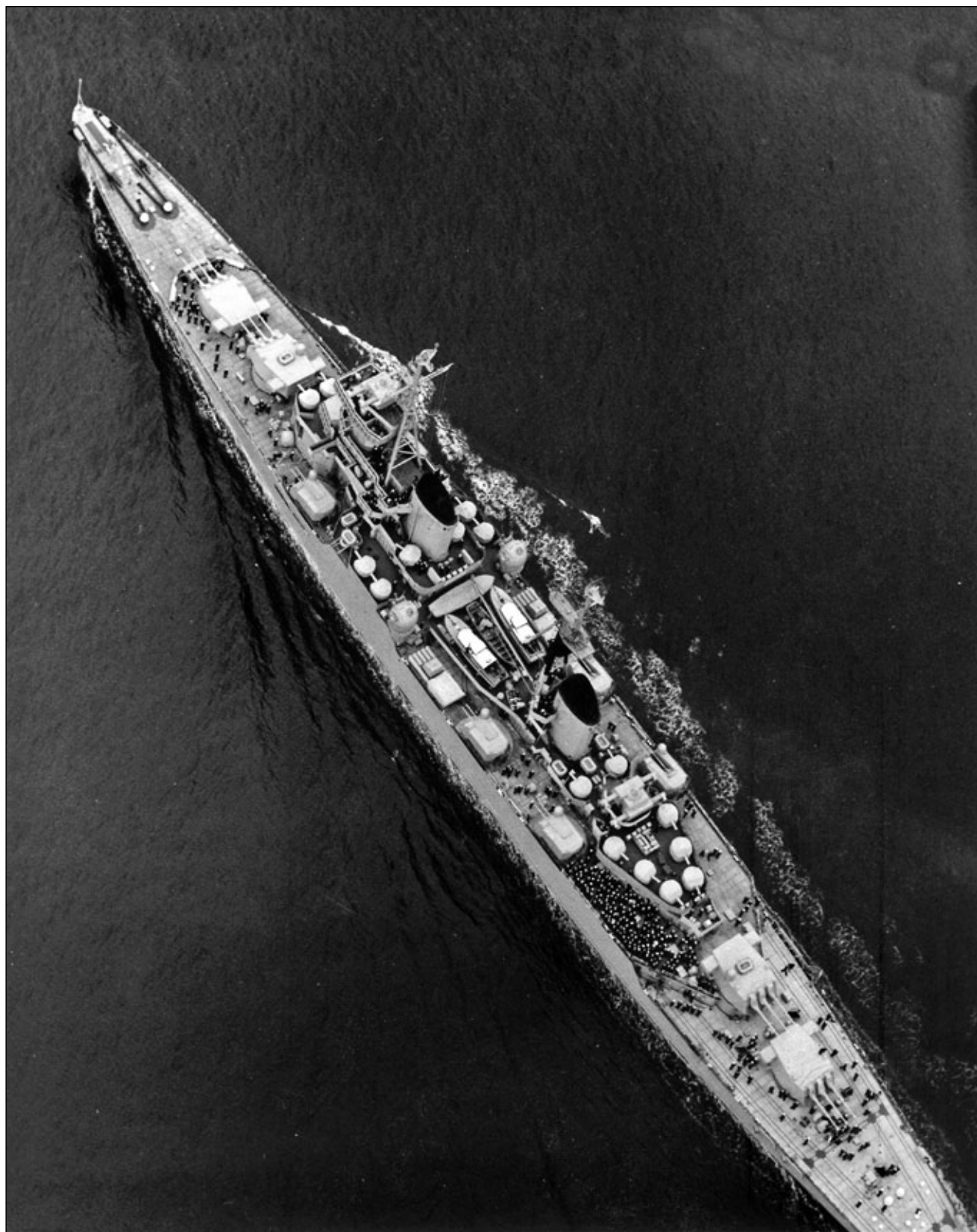
Ładne ujęcie z lotu ptaka krążownika Oktyabrskaja Rewolucija (eks- Molotowsk ) z początków służby. Na śródkręciu widoczne niezdemontowane jeszcze aparaty torpedowe. Fot. zbiory Arthur D. Baker III
