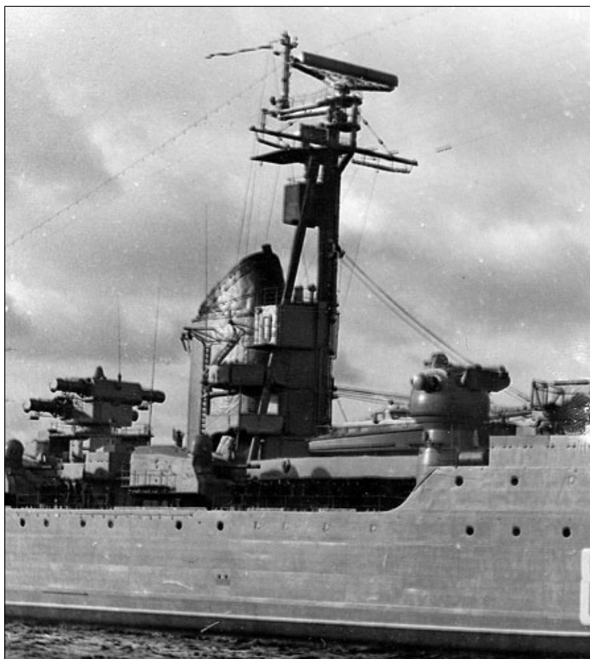
Krążownik Aleksander Newskij w 1981 r. Na wzmocnionym grotmaszcie widoczny masywny radar P-500.
