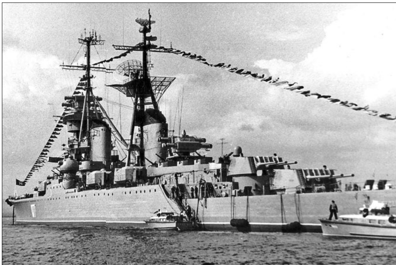
Krążownik Aleksander Newskij w 1981 r. Na wzmocnionym grotmaszcie widoczny masywny radar P-500.
