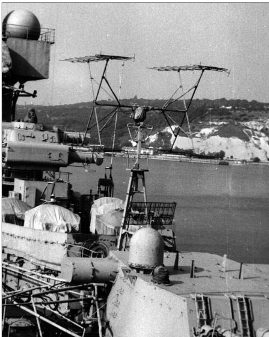
Charakterystyczny kształtem radar P-10 na krążowniku Michail Kutuzow , poniżej niego widoczna antena emitera NRZ-1. Fot. zbioru Władimir Zablockij
