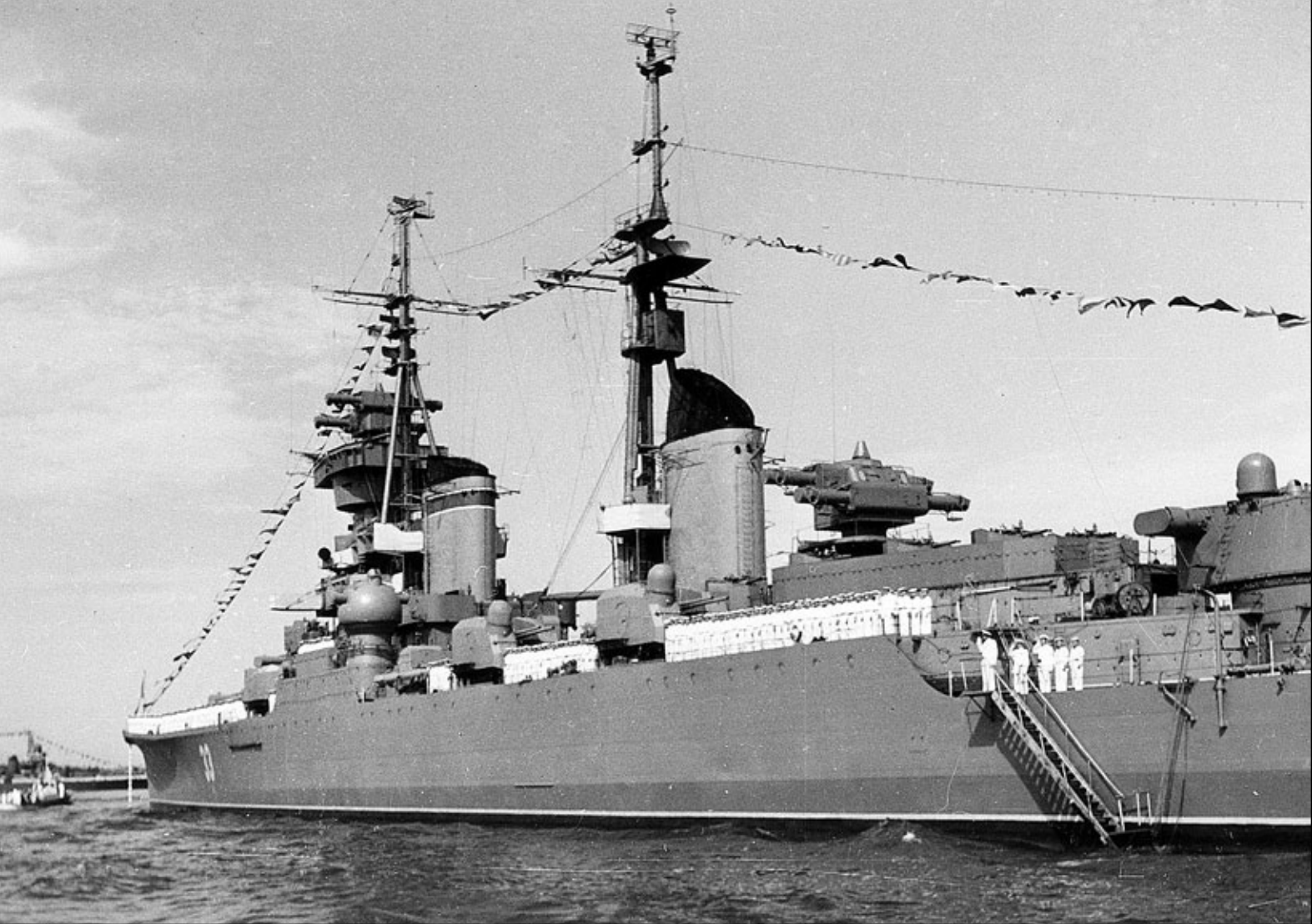
Krążownik Admirał Nachimow na paradzie w Sewastopolu w 1954 r. Widoczne pierwotne wyposażenie radarowe jednostek tego typu Fot. zbiory Siergiej Bałakin
