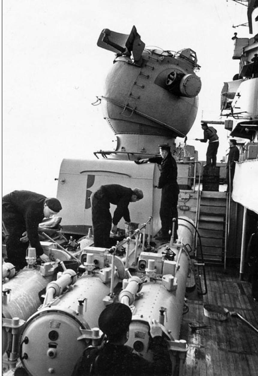
Lewoburtowy aparat torpedowy na krążowniku Admirał Uszakov w latach 1954-55. Trzeba przyznać, że w tym okresie było to już uzbrojenie anachroniczne dla jednostek tej klasy z powodu szybkiego rozwoju radiolokacji. Fot. zbiory Siergiej Bałakin
