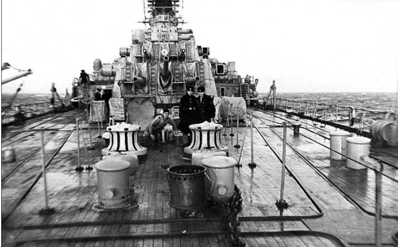
Ciekawe ujęcie pokładu rufowego krążownika Admirał Uszakov , bardzo dobrze widoczne tory minowe.
