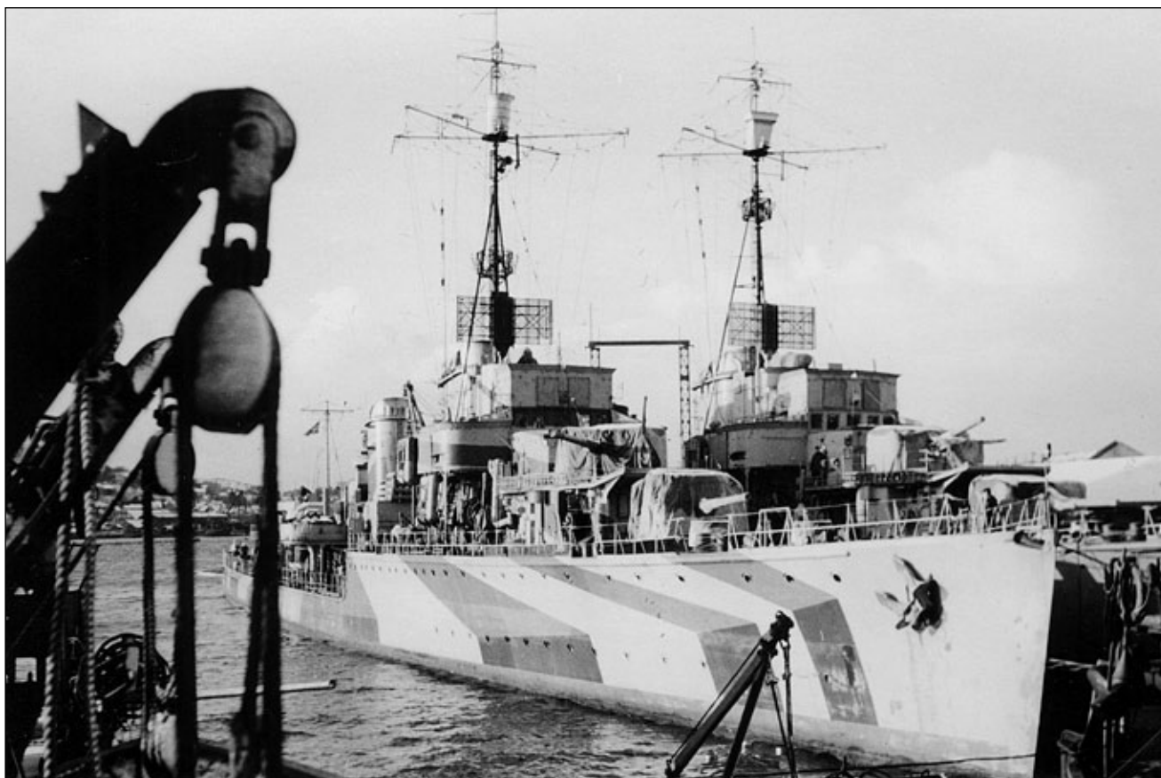
Erich Steinbrinck (Z 15) na pierwszym planie, za nim Friedrich Ihn (Z 14). Fotografia pochodzi prawdopodobnie z roku 1942. Zwraca uwagę różne umiejscowienie „materaców” urządzenia radiolokacyjnego FuMO. Fot. zbiory Andrzej Danilewicz
