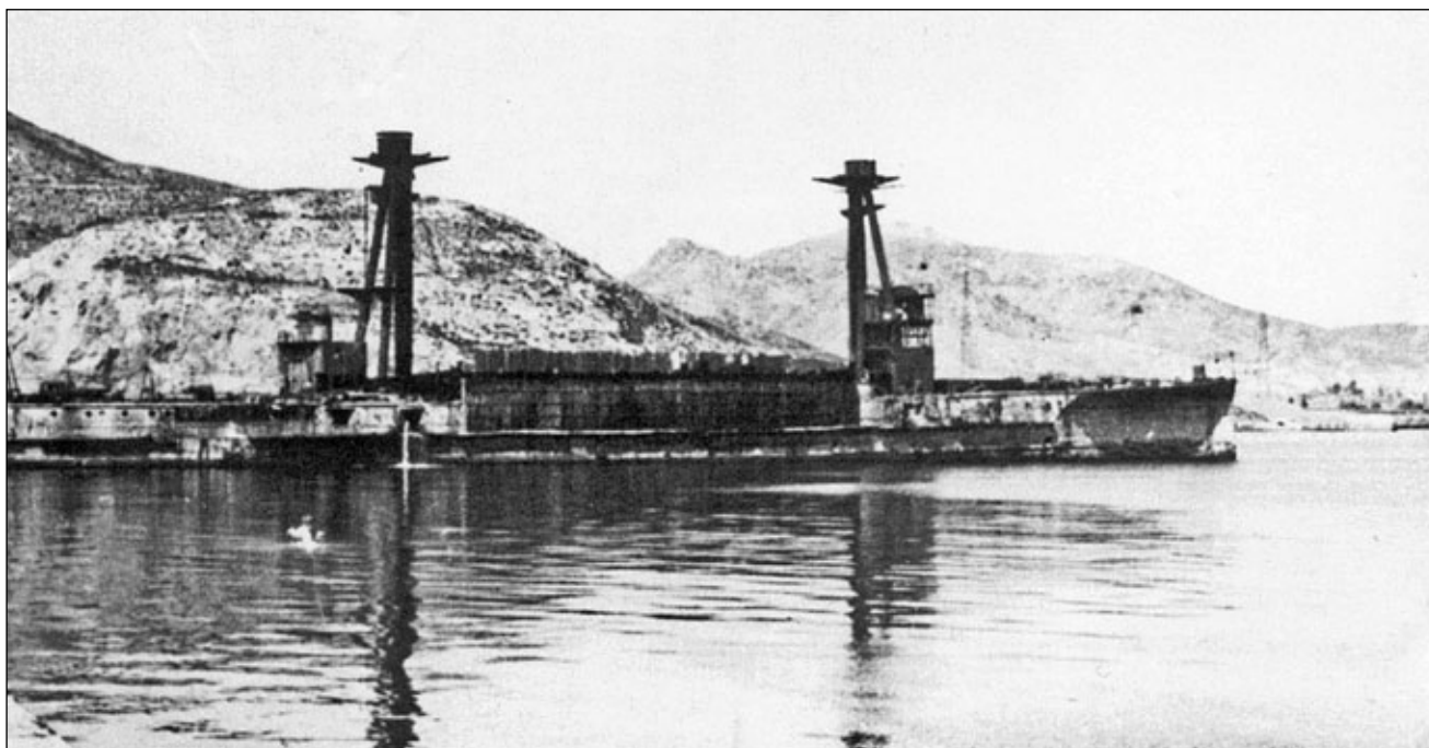
Wrak Jaime I po podniesieniu, wieże dział 305 mm zdemontowane, rejon największych zniszczeń obudowany drewnianymi belkami.
