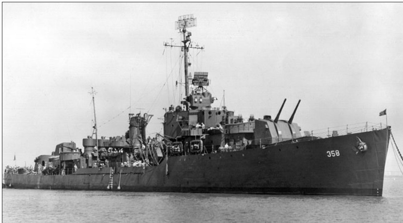
McDougal na fotografii z maja 1945 roku, po ostatniej swojej modernizacji. Na rufie widoczny maszt anteny HF-DF. Fot. zbiory Artur D. Baker III
