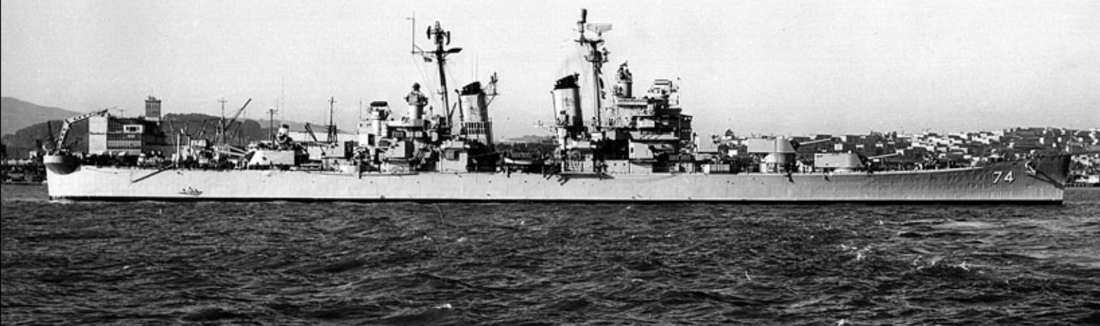
Krażownik Columbus (CA-74) w dniu 14 stycznia 1957 roku po zakończeniu planowego przeglądu w stoczni marynarki w San Francisco. Na maszcie przednim okrętu stacja dozoru powietrznego SPS-6B, na tylnym wysokościomierz radiolokacyjny SPS-8A. Dalocelowniki artylerii uniwersalnej Mk 37 zostały wyposażone w stacje radiolokacyjne kierowania ogniem Mk 25 z antenami kołowymi. Fot. zbiory Artur D. Baker III
