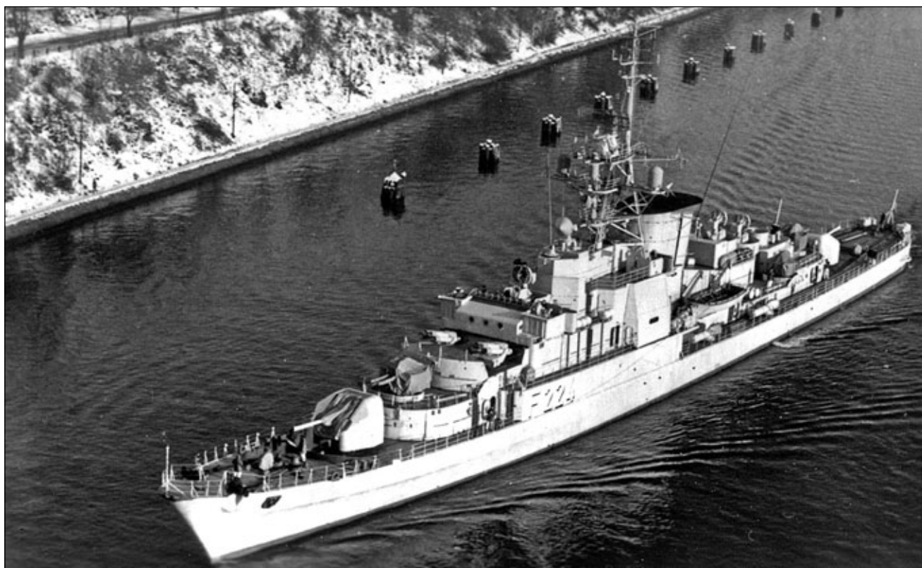
Ciekawa fotografia fregaty Lübeck wykonana w Kanale Kilońskim, która szczególnie dobrze ukazuje rozmieszczenie systemów uzbrojenia okrętu. Fot. „Wilhelmshafener Zeitung”
