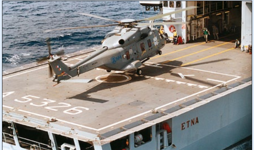
Etna posiada hangar oraz lądowisko zdolne do przyjęcia średnich śmigłowców EH 101 „Merlin” lub NH 90 bądź SH-3D „Sea King”. Na fotografii NH 90 podczas prób. Fot. NHI
