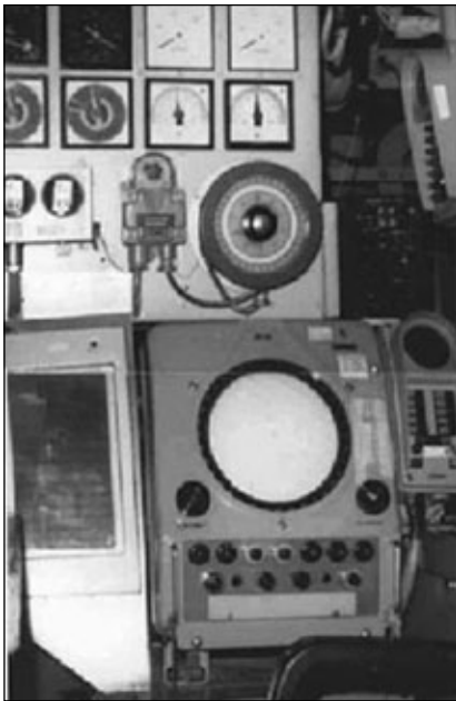
Pulpity sonaru (z lewej), grupy radiostacji (w środku) oraz systemów szyfrowych i dalekopisów (z prawej). Fot. via Ulrich Fricke
