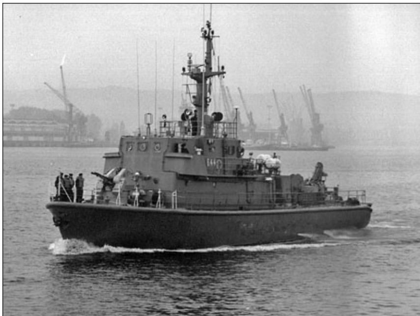
Ogromnym skokiem technologicznym była budowa serii trałowców redowych proj. 207 o kadłubach z laminatów poliestrowo-szklanych. Na fotografii Wigry (proj. 207M), który wszedł do służby już po przemianach ustrojowych w naszym kraju. Fot. Marian Kluczyński
