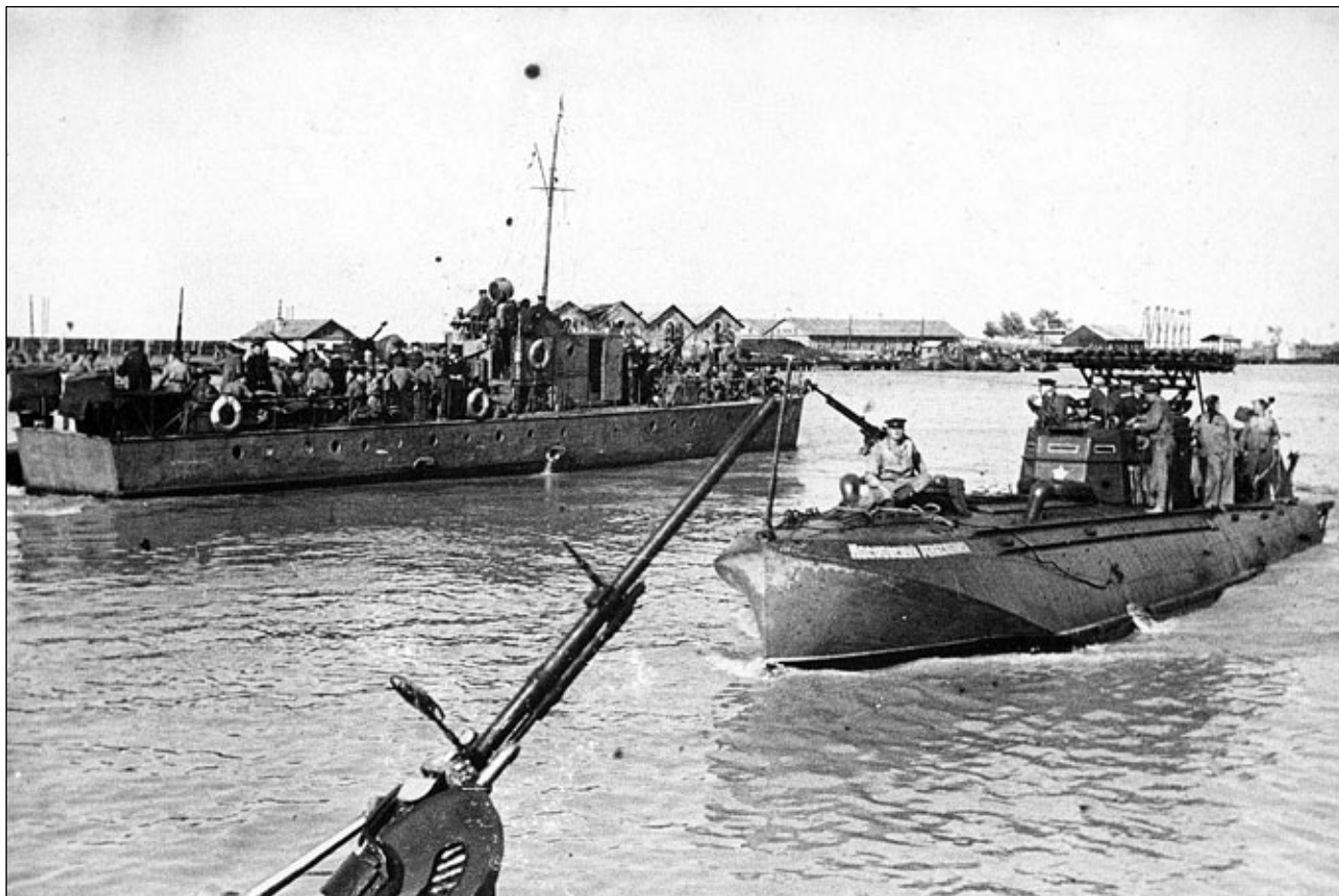
Kuter z zamontowaną wyrzutnią pocisków rakietowych M-8-M (artyleryjski) Nr 106 o nazwie Maskowskij riemieslnik trudowych rieżerwow . Na drugim planie okręt dozorowy typu „MO-4”. Fot. zbiory Siergiej Bałakin
