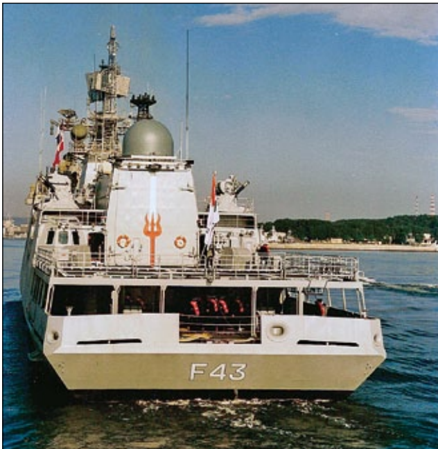
Ciekawe ujęcie fregaty Talwar od rufy z widocznym hangarem dla śmigłowca Kamow Ka-28. Fot. Andrzej Nitka
