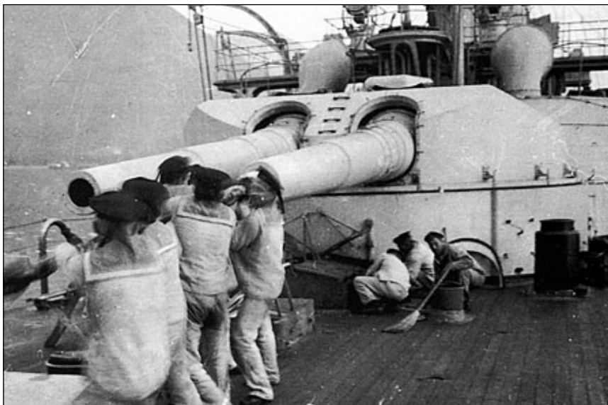
Czyszczenie lufy lewego dział kal. 240 mm rufowej wieży artyleryjskiej Wien . Prace przeprowadzane w styczniu 1916 w Bocche di Cattaro, przed lub w czasie niemieckiej i austro-węgierskiej ofensywy przeciwko Czarnogórze. Fot. zbiory Lothar Baumgartner
