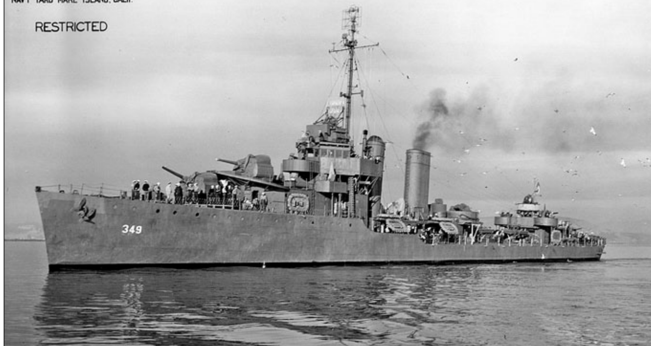
Dewey po remoncie na fotografii z 1 grudnia 1942 roku. Za drugim kominem wyraźnie widoczne nowo zainstalowane podwójne działka Bofors 40 mm w miejsce czterech Oerlikonów 20 mm. Fot. zbiory Arthur D. Baker III
