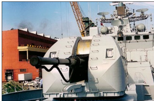
Armata uniwersalna Arsenál A 190 E kal. 100 mm. Fot. Andrzej Nitka
