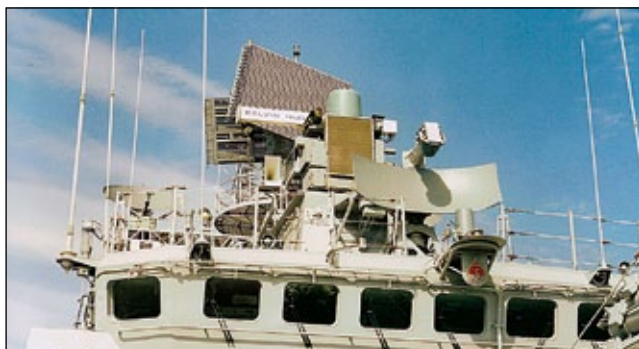
Ujęcie pomostu z przodu, na jego dachu widoczny radar kierowania ogniem 3C25 Garpun E. Fot. Andrzej Nitka
