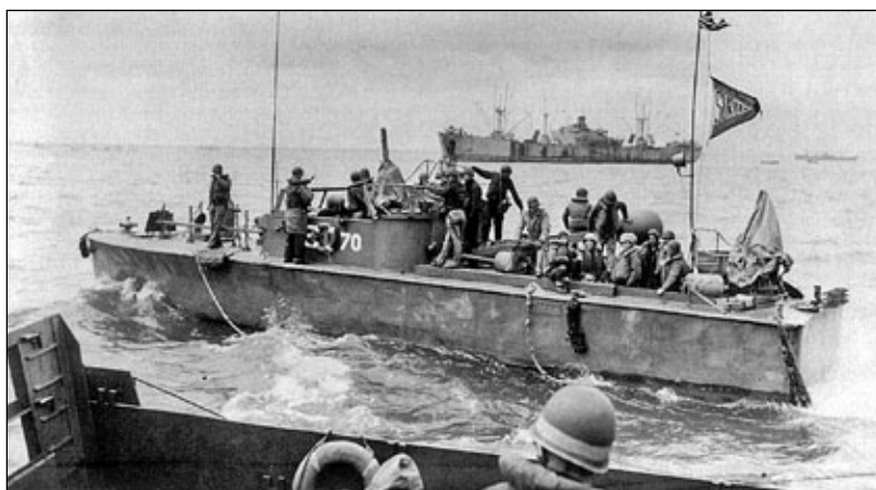
LCC-70 – jeden z kutrów kierowania lądowaniem wersji Mk1 pełniący rolę pomiarowej jednostki hydrograficznej w pierwszym dniu lądowania w Normandii. Dwie z dziobowych radiowych anten prętowych okrętu zdemontowano, a maszt z anteną radaru został obniżony.
