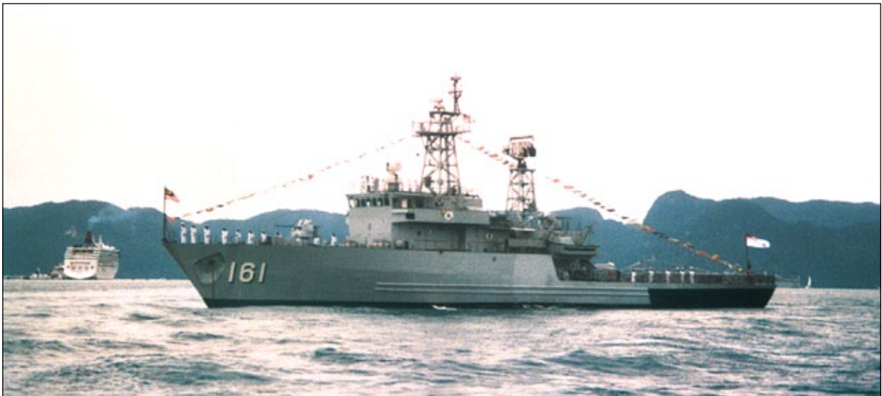
Korweta Marikh typu Muytarii w miejsce dziobowej armaty kal. 100 mm otrzymała 40 mm Boforsa.
