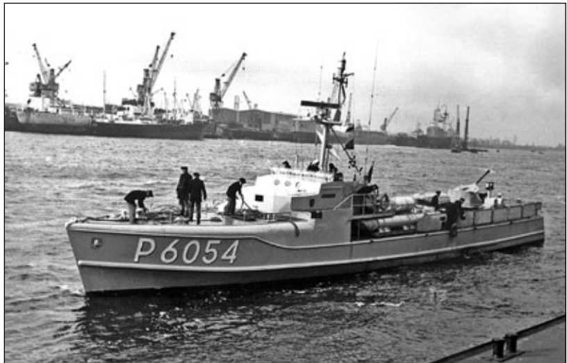
Wildschawn (P 6054) około roku 1962 w Hamburgu. Jego uzbrojenie składa się z dwóch wyrzutni torped i armaty Bofors kal. 40 mm.
