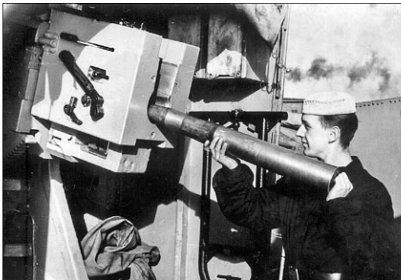
Ładowanie działka 85 mm nabojem ćwiczebnym, widoczny zamek działka.
