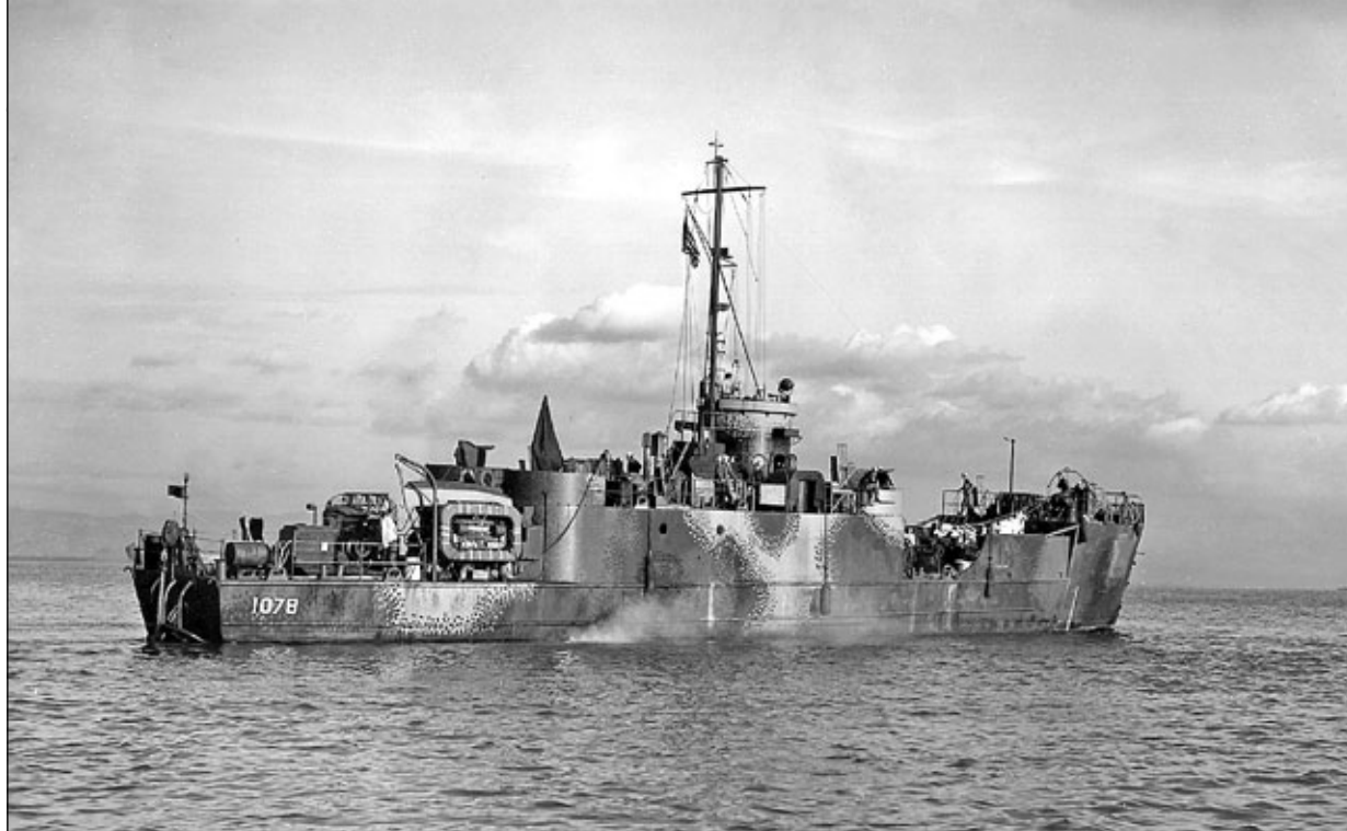
LCI(L)-1078 – duży kuter desantowy piechoty typu LCI(L)-351. Pod koniec wojny 49 okrętów tej serii zostało przystosowanych do służby w roli kutrów dowodzenia flotyllami jednostek desantowych LC(FF). fot. zbioru Arthur D. Baker III
