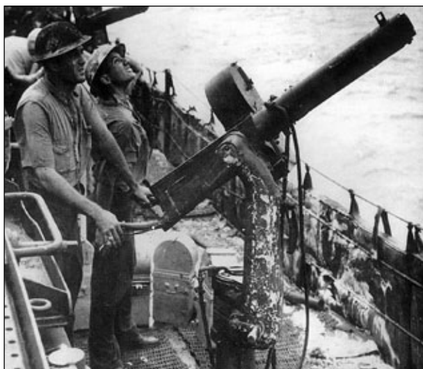
Chłodzone wodą karabiny maszynowe kalibru 12,7 mm L/90 M2 Browning uzupełniały małokalibrowe uzbrojenie przeciwlotnicze lotniskowców typu Yorktown we wczesnym okresie ich służby. Począwszy od końca 1942 roku były sukcesywnie zastępowane na okrętach pierwszej linii działkami kalibru 20 mm Oerlikon.
