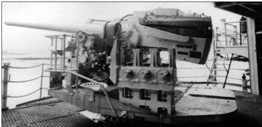
Jedno z dział artylerii uniwersalnej kalibru 127 mm L/38 Mk 12 Yorktown usytuowane na odkrytym stanowisku Mk 24 na galerii otaczającej pokład lotniczy. Fot. U.S. Naval Historical Center
