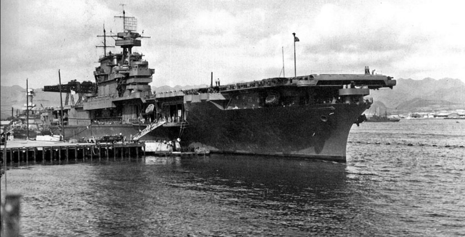
Enterprise w maju 1942 roku u nabrzeża wyspy Ford w Pearl Harbor. Okręt w kamuflażu ciemnoniebieskim Schemat 11. Na jego burcie doskonale widoczna wiązka przewodów demagnetyzacyjnych. Za rufą lotniskowca zatopiony pancernik California (BB-44). Fot. U.S. Naval Historical Center
