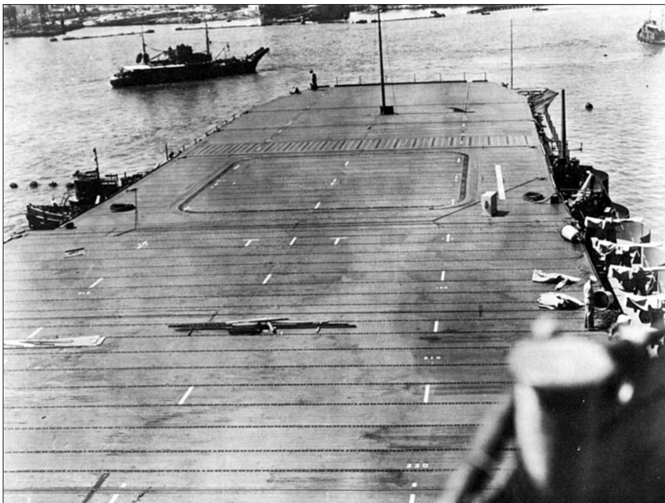
Fotografia dziobowej części pokładu lotniczego Enterprise wykonana podczas postoju okrętu w Pearl Harbor w maju 1942 roku. Widoczny przedni podnośnik samolotów oraz złożone elementy bariery końcowej przed nim. Fot. U.S. Naval Historical Center
