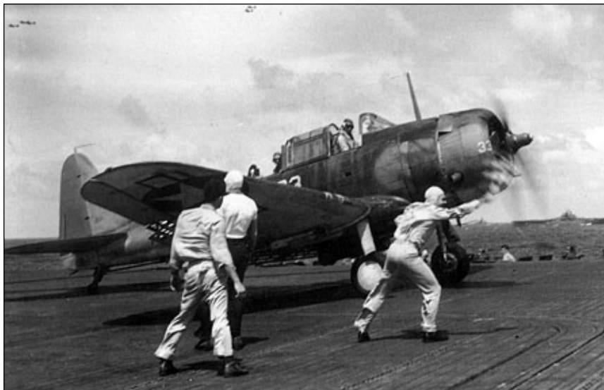
Douglas SBD „Dauntless” podczas startu z pokładu lotniskowca. Maszyny tego typu były podstawowymi bombowcami nurkującymi lotniskowców typu Yorktown. W skład dywizjonów bombowych Enterprise wchodziły aż do połowy 1944 roku. Fot. zbiory U.S. Navy
