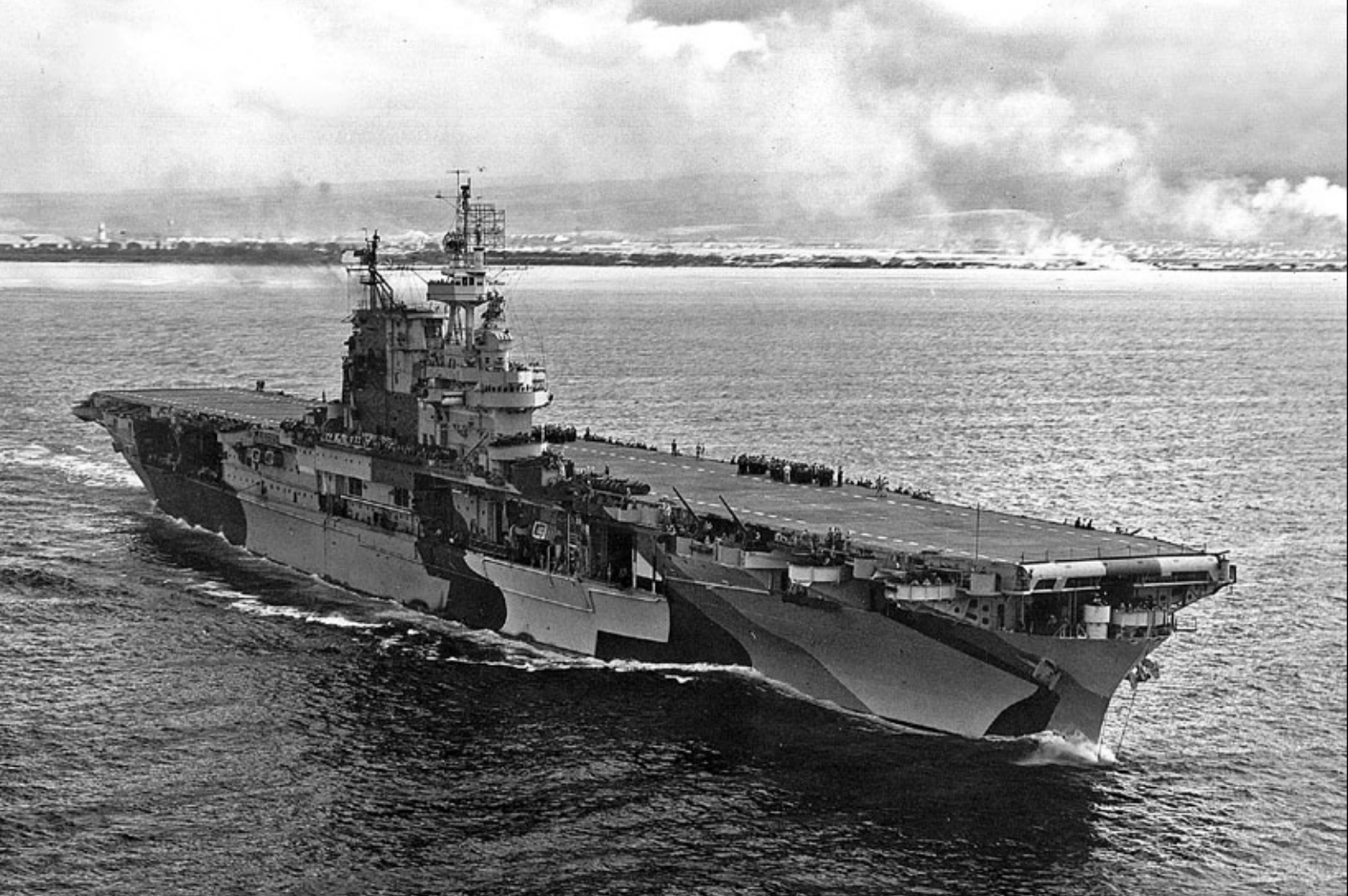
Enterprise od dziobu na fotografii wykonanej również w dniu 2 sierpnia 1944 roku. Na platformie masztu głównego okrętu widoczna antena radaru SK, za nią na topie masztu kolumnowego radaru SG, z tyłu antena wysokościomierza radiolokacyjnego SM. Fot. zbiory Arthur D. Baker III
