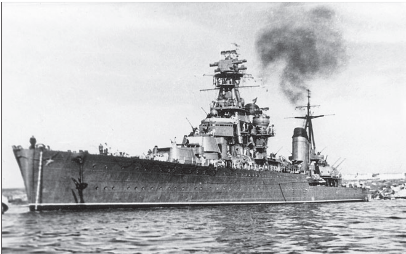
Woroszyłow w okresie powojennym. Widoczna bateria armat plot kal. 37 mm typu 70-K ustawiona na dachu drugiej wieży artylerii głównej oraz rozliczne wyposażenie radarowe. Fot. zbiory Ota Janeček
