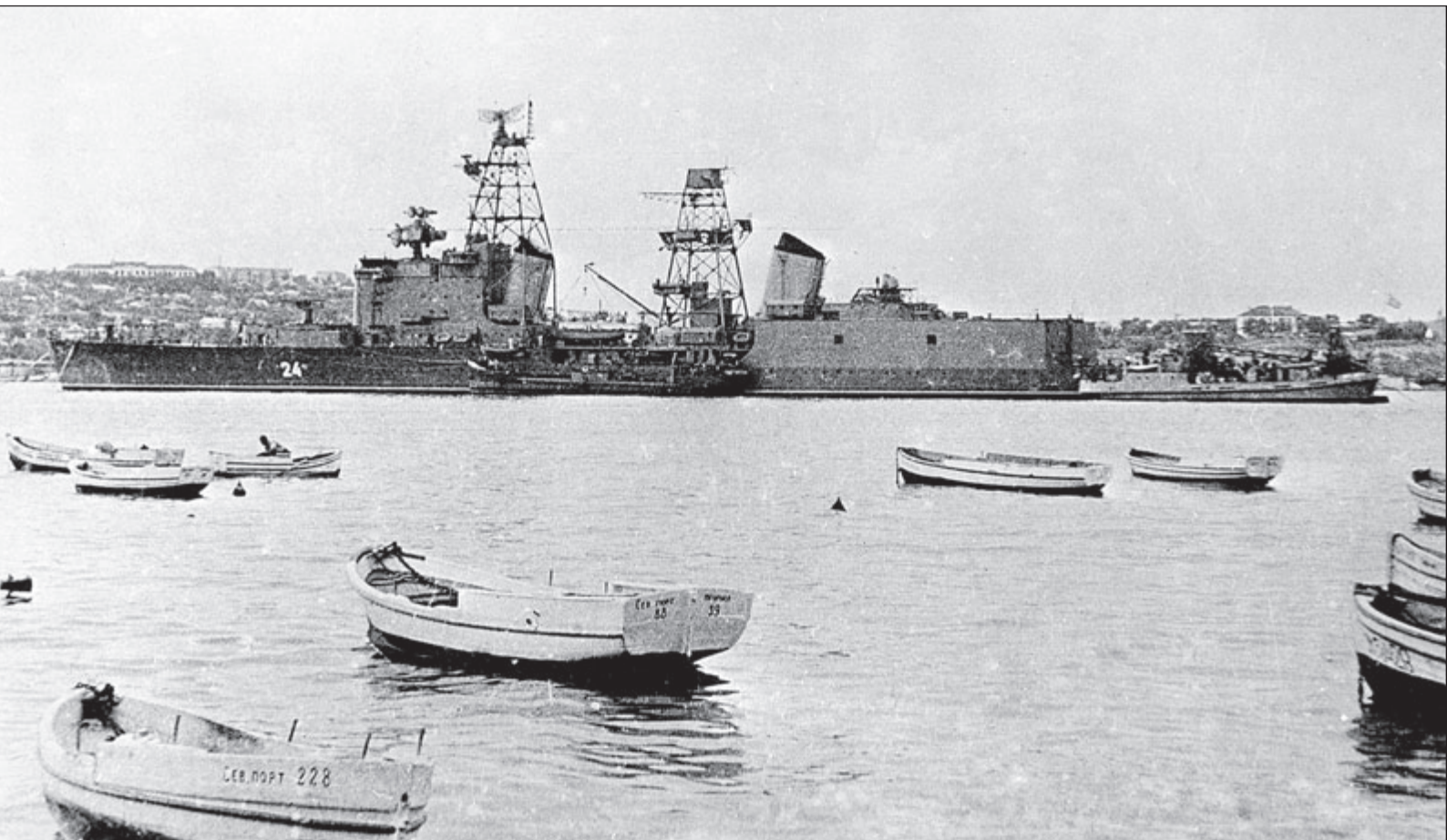
OS-24, uwagę zwracają wysokie maszty kratownicowe oraz rozliczne systemy radarowe na dziobowej nadbudówce. Fot. zbiory Siergiej A. Bałakin
