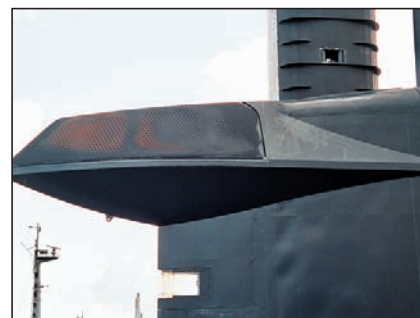
„Kogut” rozpraszający spaliny na kiosku.
