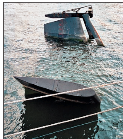
Usterzenie rufowe – widoczne urządzenie łączące z kabloliną sonaru holowanego.
