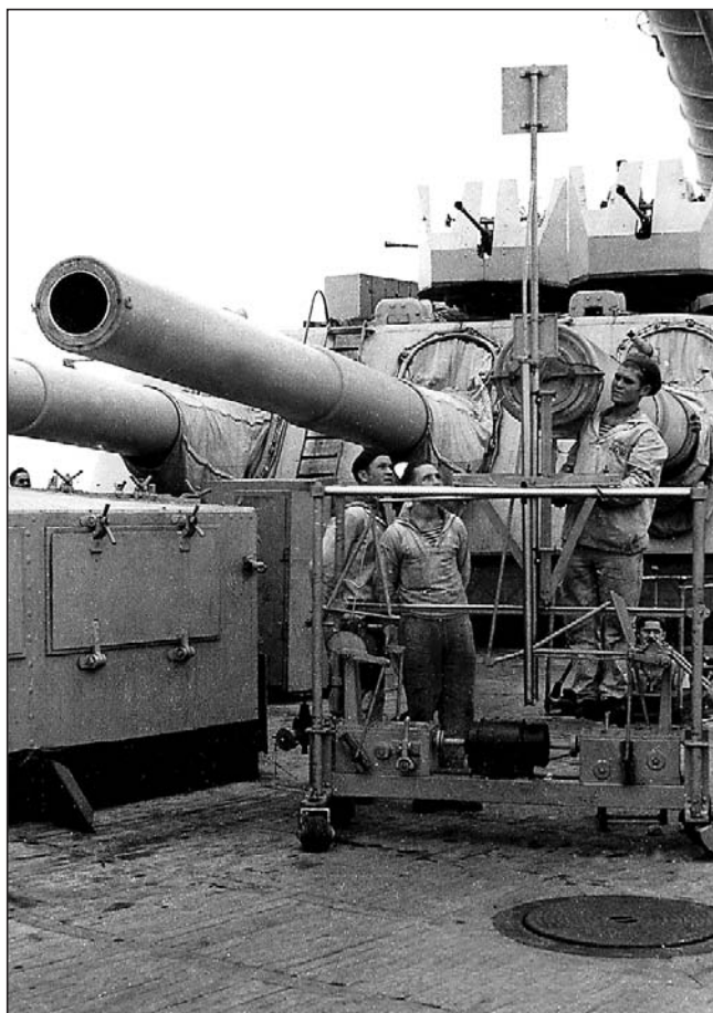
Sprawdzanie linii osiowej przewodu lufy dział głównego kalibru dla usunięcia usterek przyrządów celowniczych. fot. zbiory Anatolij N. Odajnik
