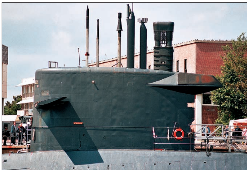
Kiosk Walrusa z kompletem urządzeń podnośnych.
