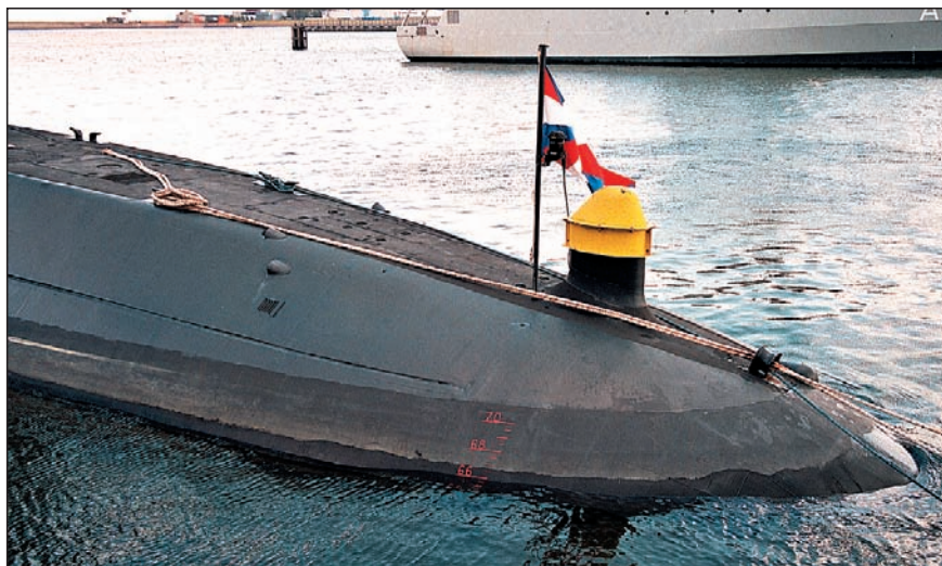
Część dziobowa z widoczną anteną sonaru.
