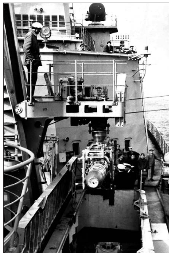
Łaładunek torpedy za pomocą systemu „Struna 1B”.
