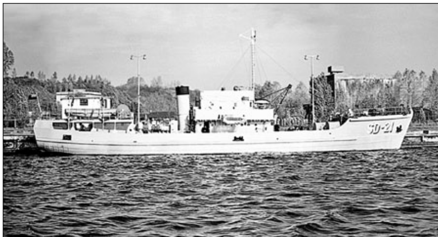
W 1956 roku do służby weszły stacje demagnetyzacyjne SD-21 (na fotografii) oraz SD-22. Były to przebudowane trawlerzy Uran i Urania , otrzymane z dostaw UNRRA, eks-drewnianej wojennej budowy brytyjskie trawlerzy typu „MMS”, dlatego doskonale nadawały do przebudowy w tym celu. Fot. Stanisław Pudlik
