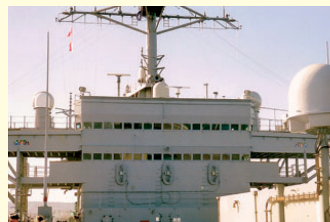
Przednia ściana nadbudówki z dwoma pomostami: nawigacyjnym i sztabowym. Nad nimi radary nawigacyjne Marconi SPS-59 (LN66) i Raytheon SPS-64(V)9.
