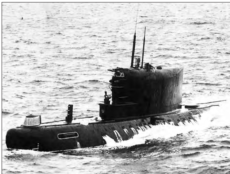
Jeden z wycofanych ze służby operacyjnej okrętów projektu 658, po przebudowie na jednostkę doświadczalną, nowych systemów wykrywania kilwaturowo zanurzonych okrętów podwodnych. fot. Royal Navy via Norman Friedman
