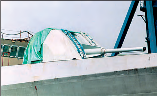
Nowe działo kal. 100 mm zabudowane na pokładzie dziobowym niszczyciela Yantai , rzeczywiście bardzo przypomina swój francuski pierwowzór. fot. Internet
