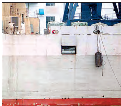
Wyrzutnie torpedowe niszczyciela Yantai . fot. internet
