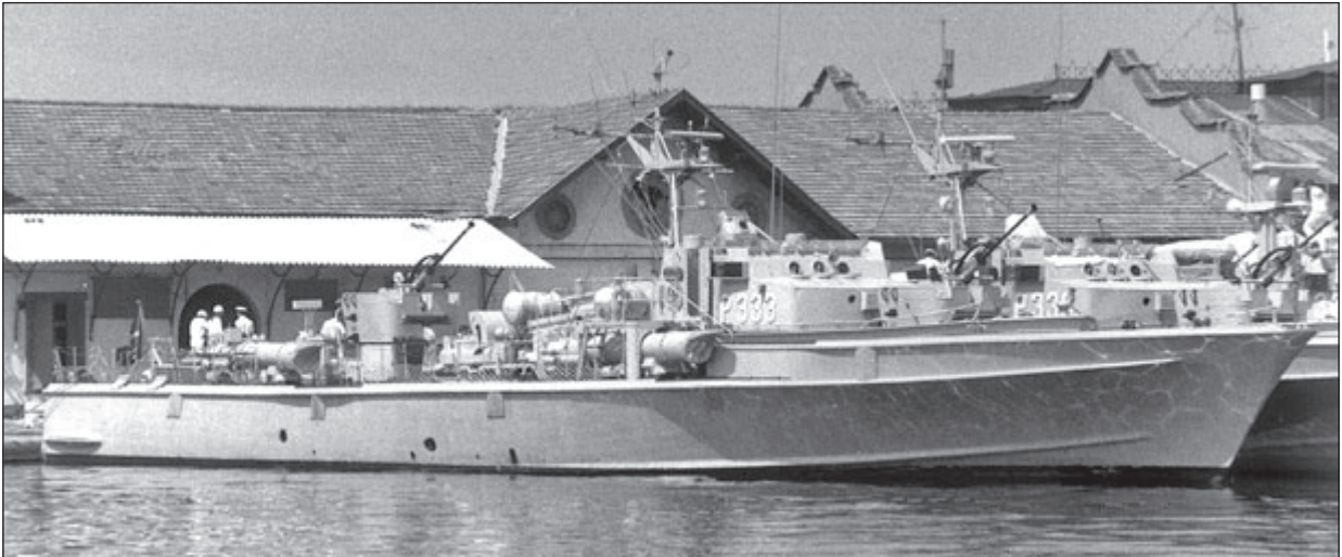
Turecki kuter torpedowy Mizrak (P 333), eks- Häher , a za nim Karayel (P 336), eks- Pinguin , 30 maja 1986 r. w Izmirze. Armaty kal. 40 mm zostały dodatkowo wyposażone w automatyczne urządzenia załadownicze.
