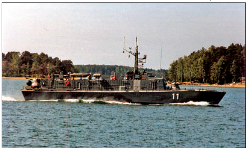
Tuima po przebudowie na szybki stawiacz min z kutra rakietowego, 13.05.1993 r.
