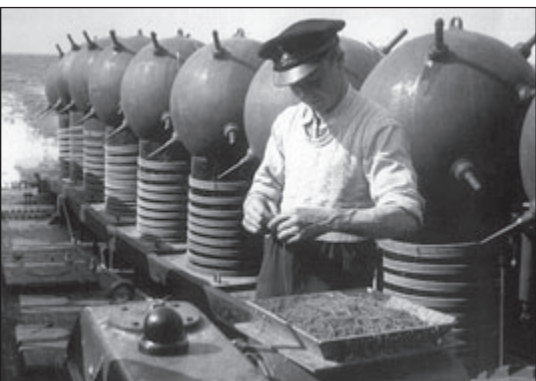
Mechanik Ruokonen przygotowuje na pokładzie Ruotsinsalmi zapalniki do niemieckich min typu EMC, 19 czerwca 1942 r.
