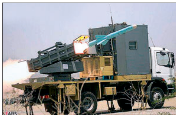
Irańska wyrzutnia rakiet „Noor” ucharakteryzowana na samochód dostawczy ze składaną osłoną. Wydaje się, że podobnej wyrzutni użył Hezbollah do ataku na Hanit .
