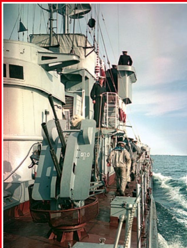
Trzy równie ciekawe fotografie ścigacza typu „Kronstadt” w morzu pochodzące z połowy lat 50-tych. Widok na prawą stronę nadbudówki z wukaemem 2M1 kal. 12,7 mm oraz dwa ujęcia rufy.
