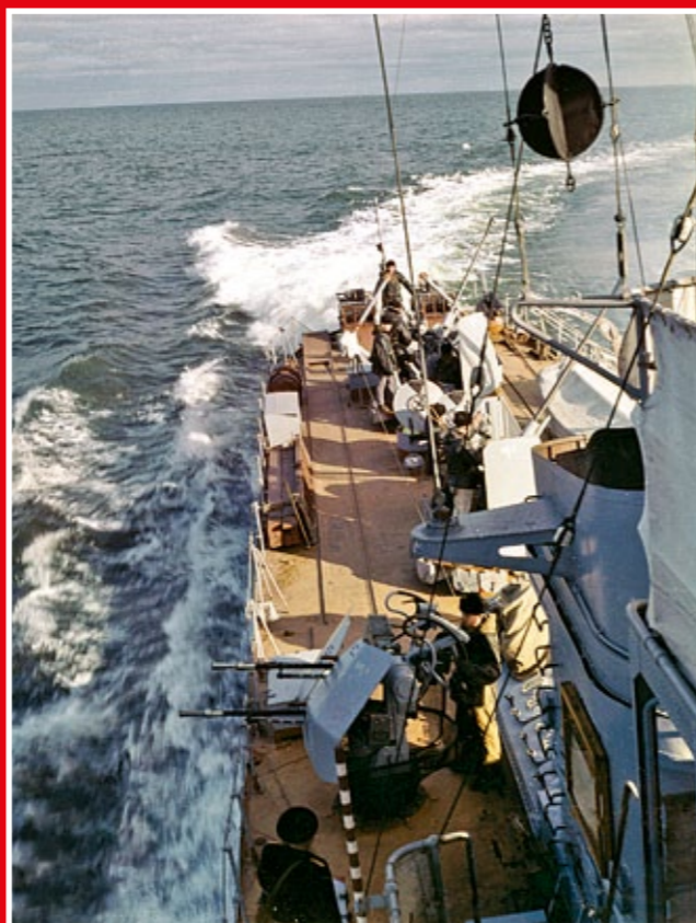
Trzy równie ciekawe fotografie ścigacza typu „Kronstadt” w morzu pochodzące z połowy lat 50-tych. Widok na prawą stronę nadbudówki z wukaemem 2M1 kal. 12,7 mm oraz dwa ujęcia rufy.
