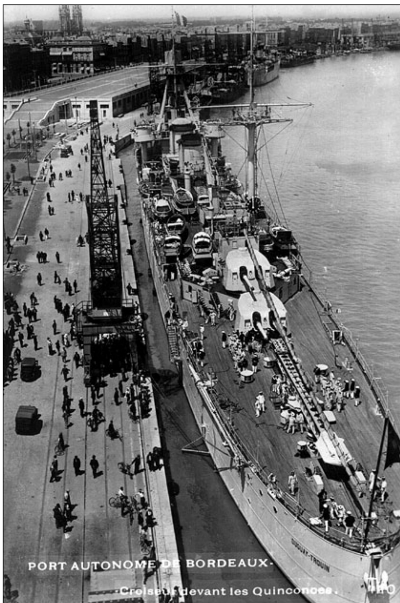
Piękne ujęcie lotnicze Duguay-Trouin zacumowanego do keji Quinconces w Bordeaux, między 6 a 9 lipca 1934 roku. Zwracają uwagę: flaga wiceadmirała Drujona z 2 Eskadry, opuszczony na rufę maszt, dwa dalcelowniki ustawione na tylnych skrzydłach pomostu.
