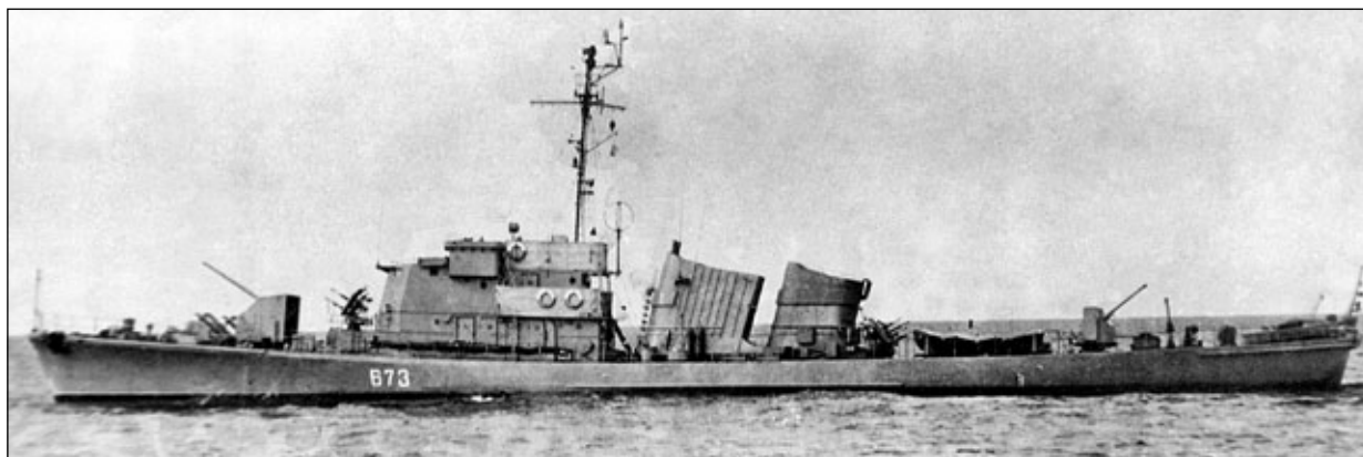
Okręt doświadczalny MPK-163 z zbudowaną turbiną gazową UGTU-2.
