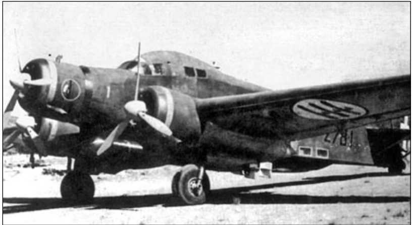
Włoskie bombowce SM-79, pomimo drewnianej konstrukcji, okazały się bardzo udanymi samolotami torpedowymi.
