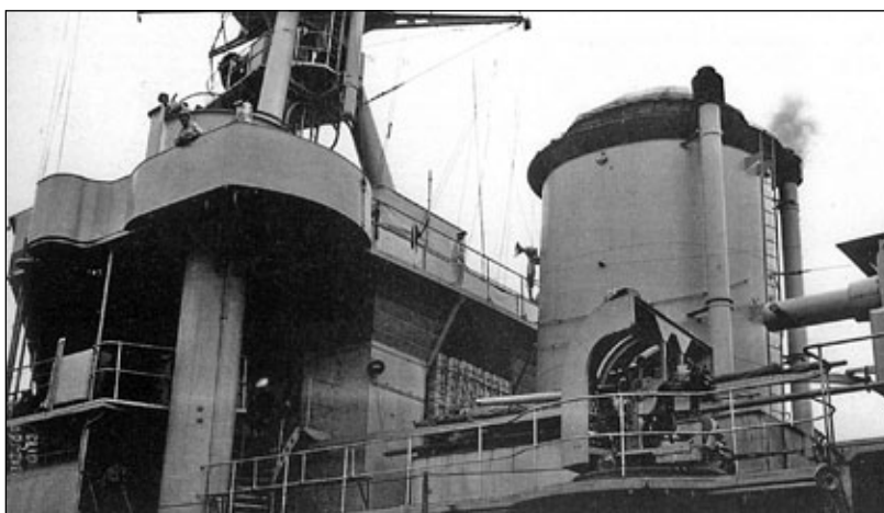
Szczegóły tylnej części pomostu na Duguay Trouin. Widoczne działa 75 mm plot z osłonami przeciwdławkowymi.
