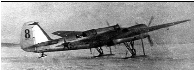
Radzieckie bombowce typu SB były standardowym uzbrojeniem lotnictwa Floty i Armii. Na fotografii wariant z podwoziem nartowym stosowany w wojnie z Finami.
