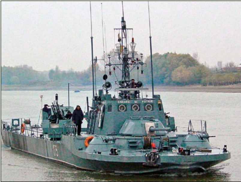
Piękne ujęcie 1/2 od dziobu dużego kutra pancernego Posada . Dobrze widoczne elementy jego uzbrojenia, wieża armaty 100 mm oraz dwie wieżyczki (wkm 14,5 mm + km 7,62 mm) na dziobie. Na śródkręciu widoczny poczwórnie sprzężony wkm kal. 14,5 mm.
