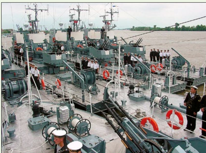
Grupa trałowców typu VD w bazie. Uwagę zwraca przebrojenie okrętów z dwulufowych w poczwórne wkm-y 14,5 mm.
