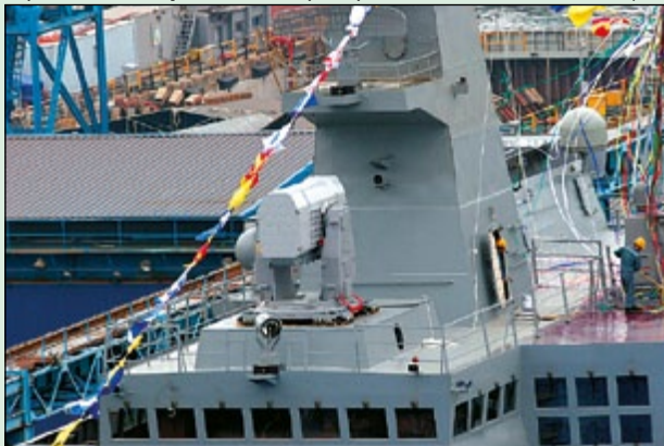
Wyrzutnia rakiet przeciwlotniczych systemu RAM. fot. Shin in Kyun
