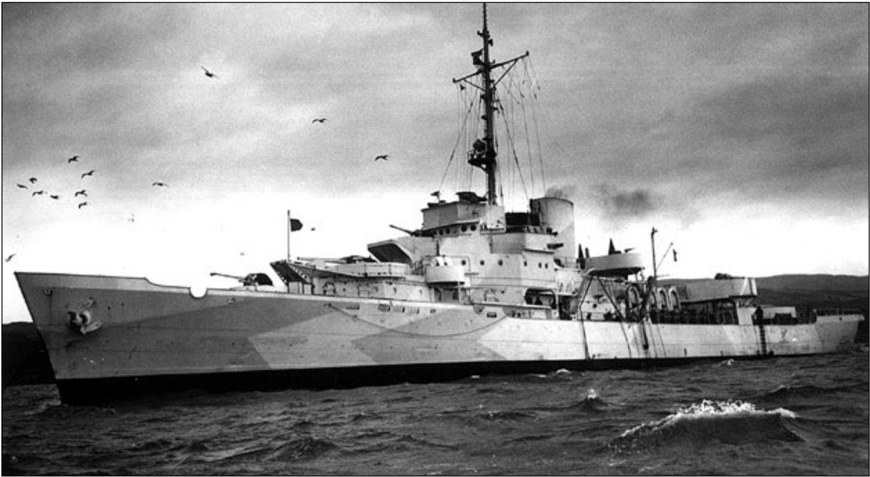
Spencer (WPG-36) w pierwotnej konfiguracji uzbrojenia i wyposażenia patrolowca amerykańskiej Straży Przybrzeżnej, z dwoma pojedynczymi działami 127 mm L/51 na odkrytych stanowiskach dziobowych. fot. zbiory Arthur D. Baker III
