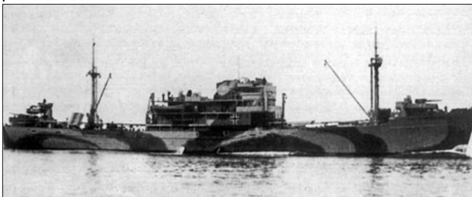
Fotografia Kiebitza z nowym uzbrojeniem: na dziobie z jedną armatą a na rufie z dwiema armatami kalibru 120 mm, które uzupełniały trzy armaty plot. kal. 37 mm i kilka poczwórnych podstaw kal. 20 mm.
