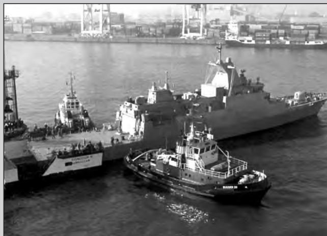
Wprowadzanie malezyjskiej korwety typu MEKO 100 RMN do ciężarowca Condock IV . fot. „Soldat und Technik”
