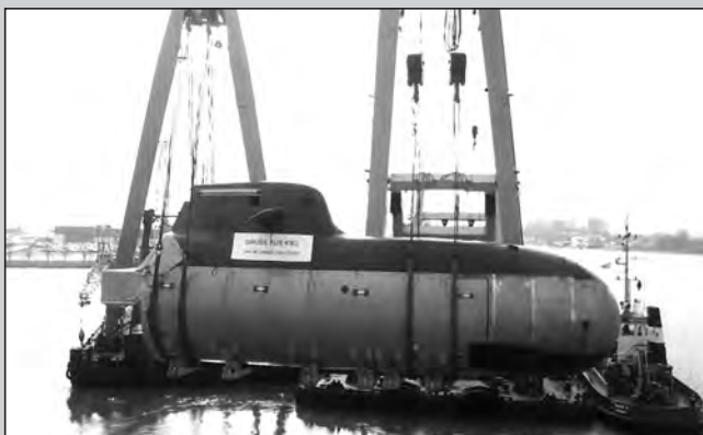
Transport sekcji dziobowej okrętu podwodnego U 32 w kilońskiej stoczni HDW. fot. „Soldat und Technik”
