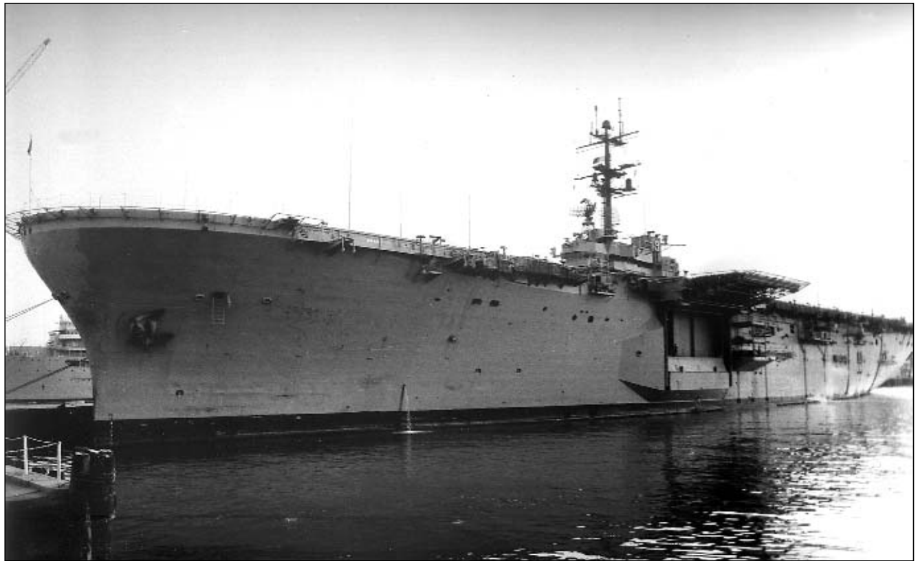
Ujęcie śmigłowcowca Guam (LPH-9) wykonane z lewej burty w bazie Norfolk w 1977 roku. Uwagę zwracają szczegóły budowy podnośnika lotniczego lewej burty. fot. zbiory Arthur D. Baker III
