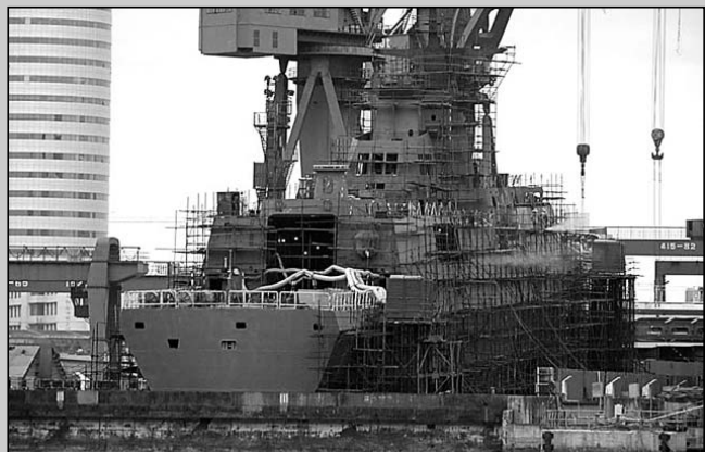
Sylwetka znajdujących się w budowie dwóch chińskich fregat typu „054” jest wzorowana na francuskich okrętach typu La Fayette . fot. internet
