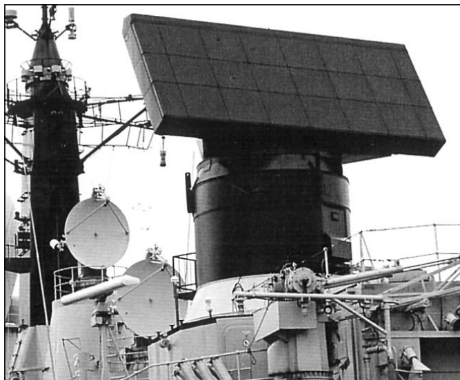
Radar dozoru przestrzeni powietrznej SMART-L przechodził wszechstronne próby morskie na pokładzie starszej fregaty Tromp w latach 1998-99. fot. Koninklijke Marine
