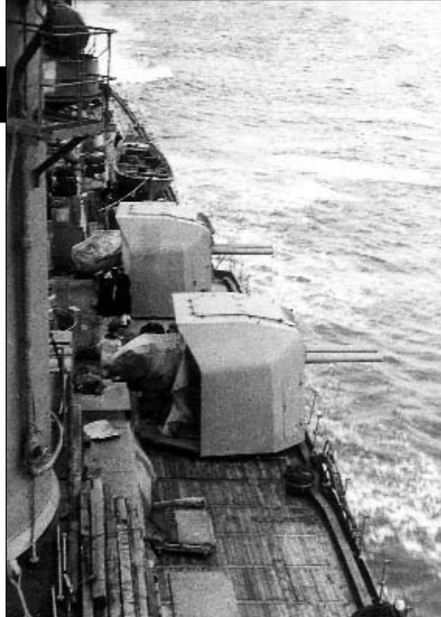
Widok prawej burty na dwie wieże dział kal. 100 mm. fot. zbiory Anatolij N. Odajnik
