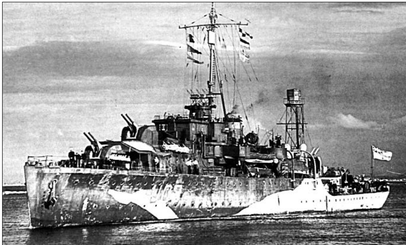
Erne w wojennym kamuflażu. Uwagę zwracają radary typu 271 (nad pomostem) i 291 (na maszcie rufowym).
