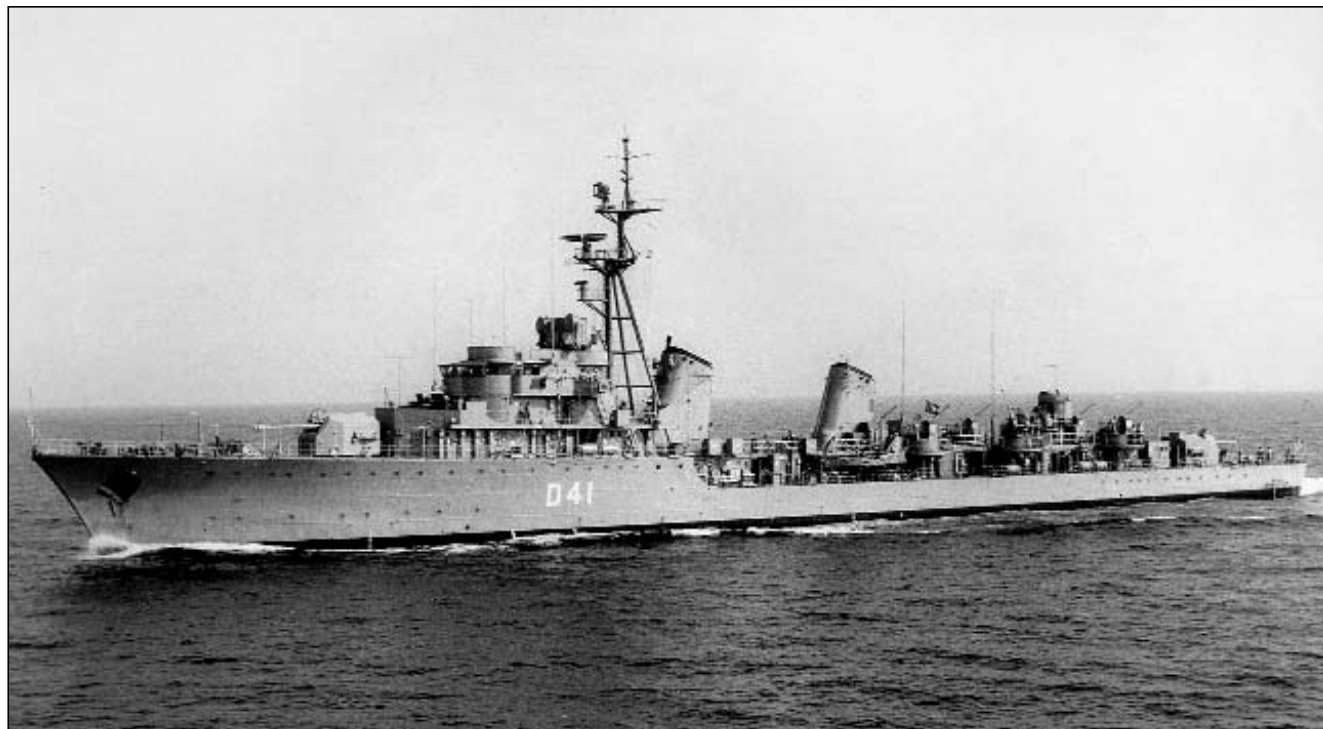
Oquendo po demontażu rufowej wieży artylerii głównej.
