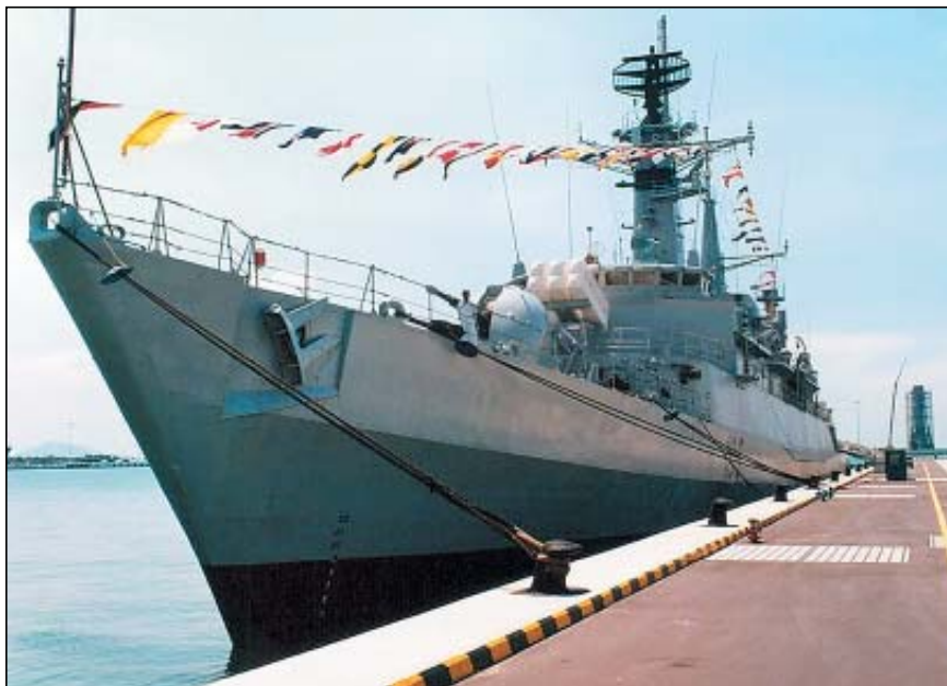
Pakistańska fregata Tippu Sultan (185) po modernizacji i montażu wyrzutni chińskich rakiet przeciwlotniczych LY-60N przed pomostem. fot. PakDef
