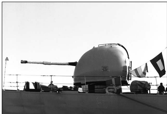
Widok dziobowej armaty Vickers Mk 8kal. 114 mm fregaty Active (F 171). fot. Rafał Ciechanowski
