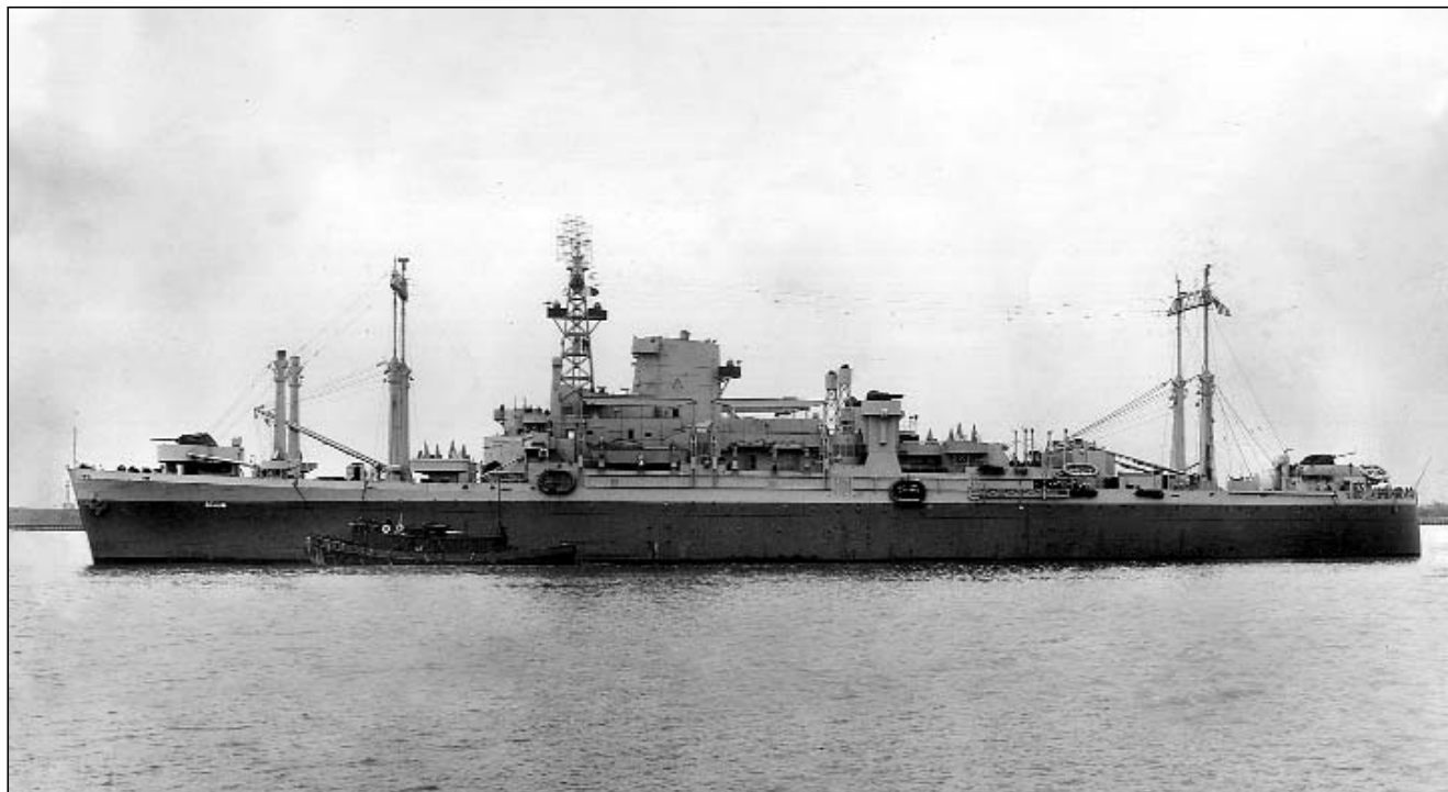
Burtowe ujęcie Ancon (AGC-4), jednostki wprowadzonej do służby jako pierwszy amerykański okręt dowodzenia siłami desantowymi. Fotografia wykonana w Norfolk Navy Yard w dniu 21 kwietnia 1943 roku. Na maszcie kratownicowym antena radaru dozoru powietrznego SK.
