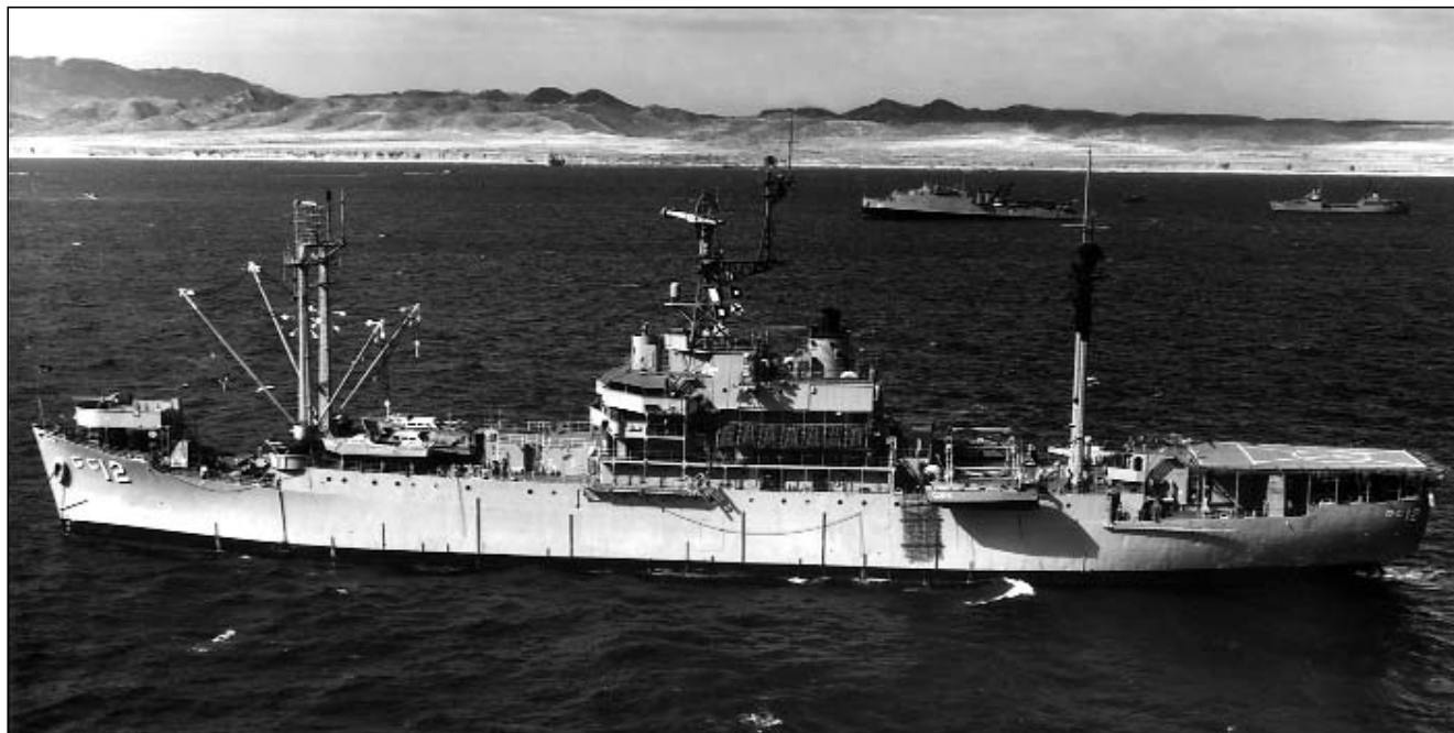
Fotografia okrętu dowodzenia siłami desantowymi Estes (AGC-12) wykonana w dniu 6 maja 1964 roku. W latach pięćdziesiątych ubiegłego wieku wszystkie pozostawione w służbie jednostki typu Mount McKinley zostały wyposażone w rufowe platformy dla śmigłowców.
