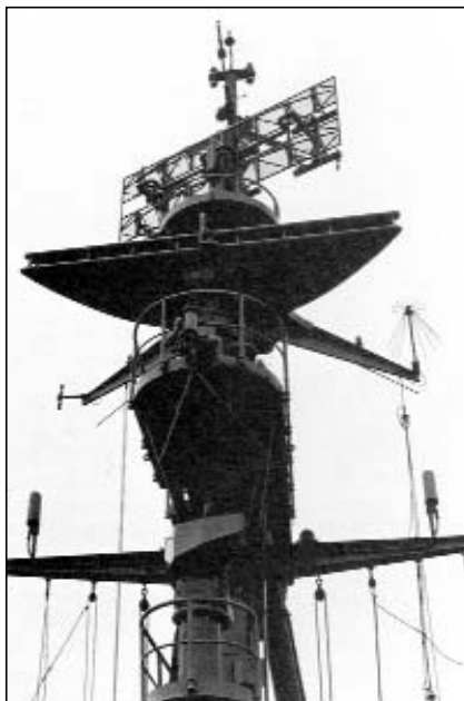
Widok na maszt Oquendo . Dobrze widoczna prostokątna kratka radaru Marconi SNW-10, a także radar w kształcie połówki sera typu 293Q. fot. zbiory Arthur D. Baker II
