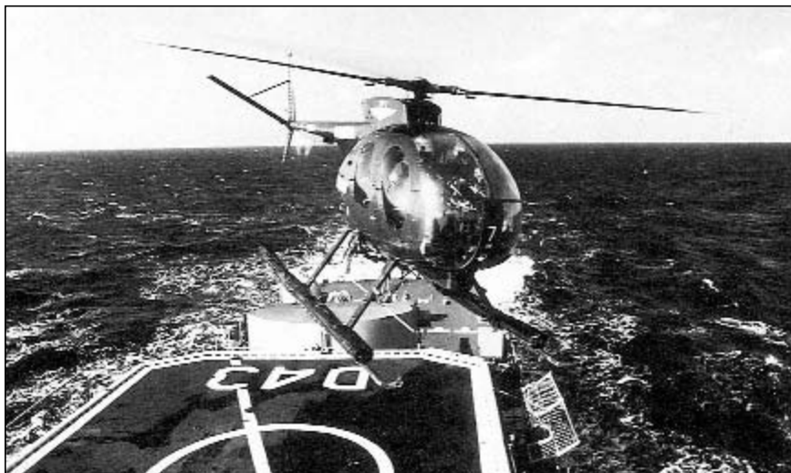
Po fiasku eksploatacji sytemu DASH oba niszczyciele przebrojono w lekkie śmigłowce Hughes 500M (ASW). Na fotografii widoczny jeden z nich startujący z pokładu Marques de la Ensenada . fot. zbiory Coello-Lillo
