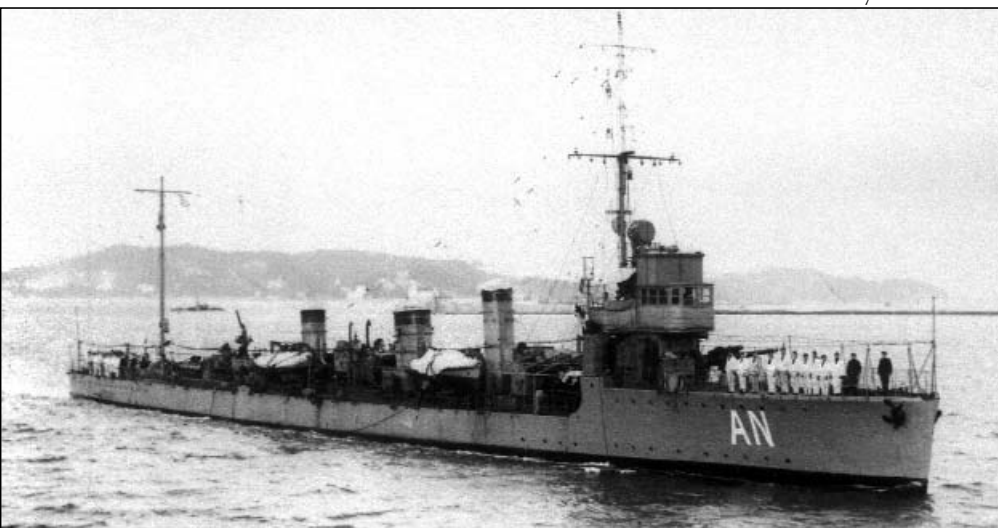
Niszczyciel Annamite z białym znakiem burtowym (AN) wychodzący z redy Tulonu w dniu 19 stycznia 1926 roku. Uwagę zwraca osłona telemetru na wysokości pomostu.
