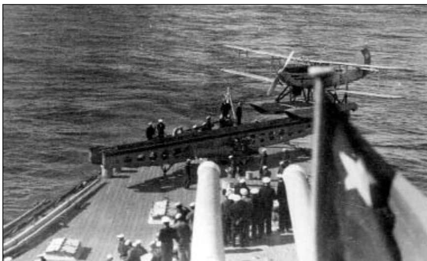
Zdjęcie rufy z katapultą i wodnosamolotem Fairey IIIF, przygotowanym do startu. Na pokładzie widoczny żurawik do podnoszenia wodnosamolotu, po jego lądowaniu na wodzie. Prawdopodobnie fotografia przedstawia pierwszy start w 1932 roku.
