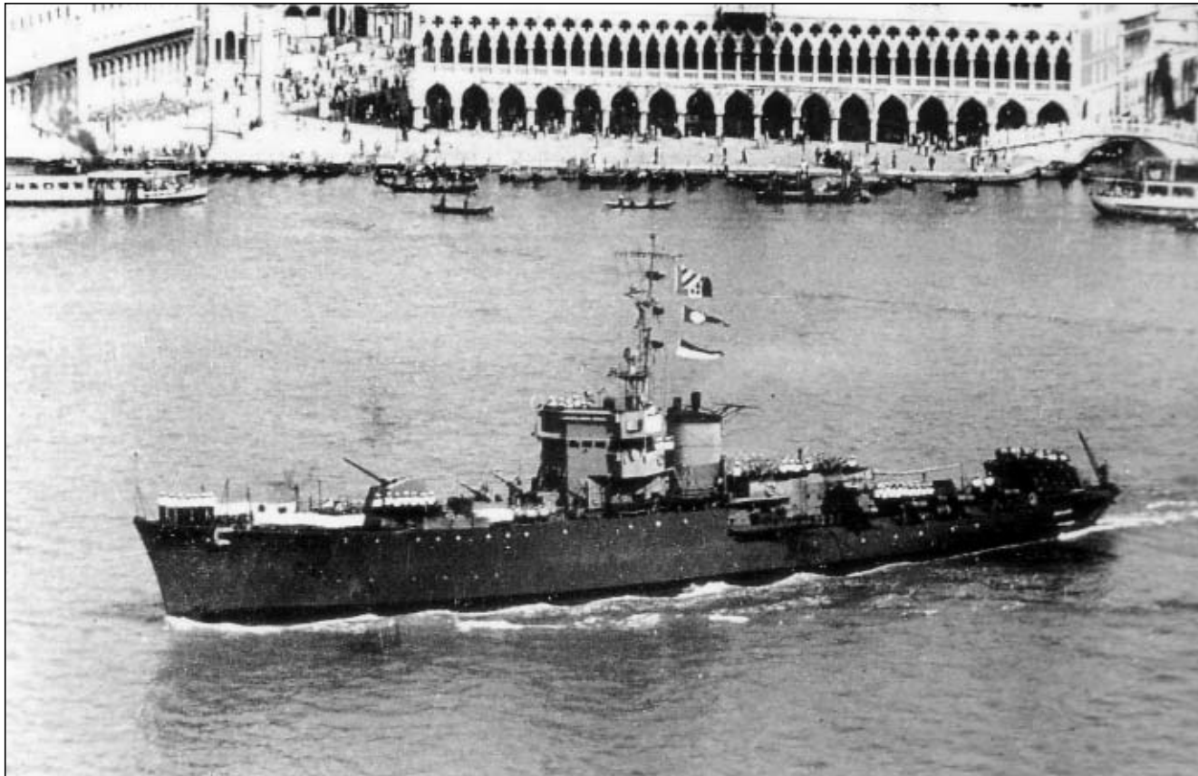
Korweta Driade na tle weneckiego Pałacu Dożów w sierpniu 1945 r. Jednostka wyposażona jest jeszcze w zrzutnie bomb głębinowych typu „Gatteschi”. Również pozostałe uzbrojenie nie zostało jeszcze zmienione. fot. zbiory Achille Rastelli
