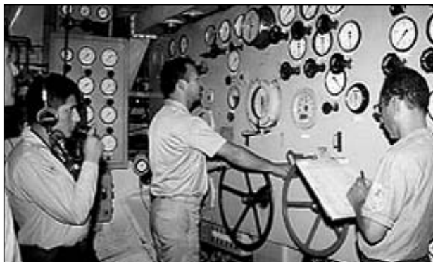
Stanowisko kierowania pracą głównych turbin Almirante Grau .
