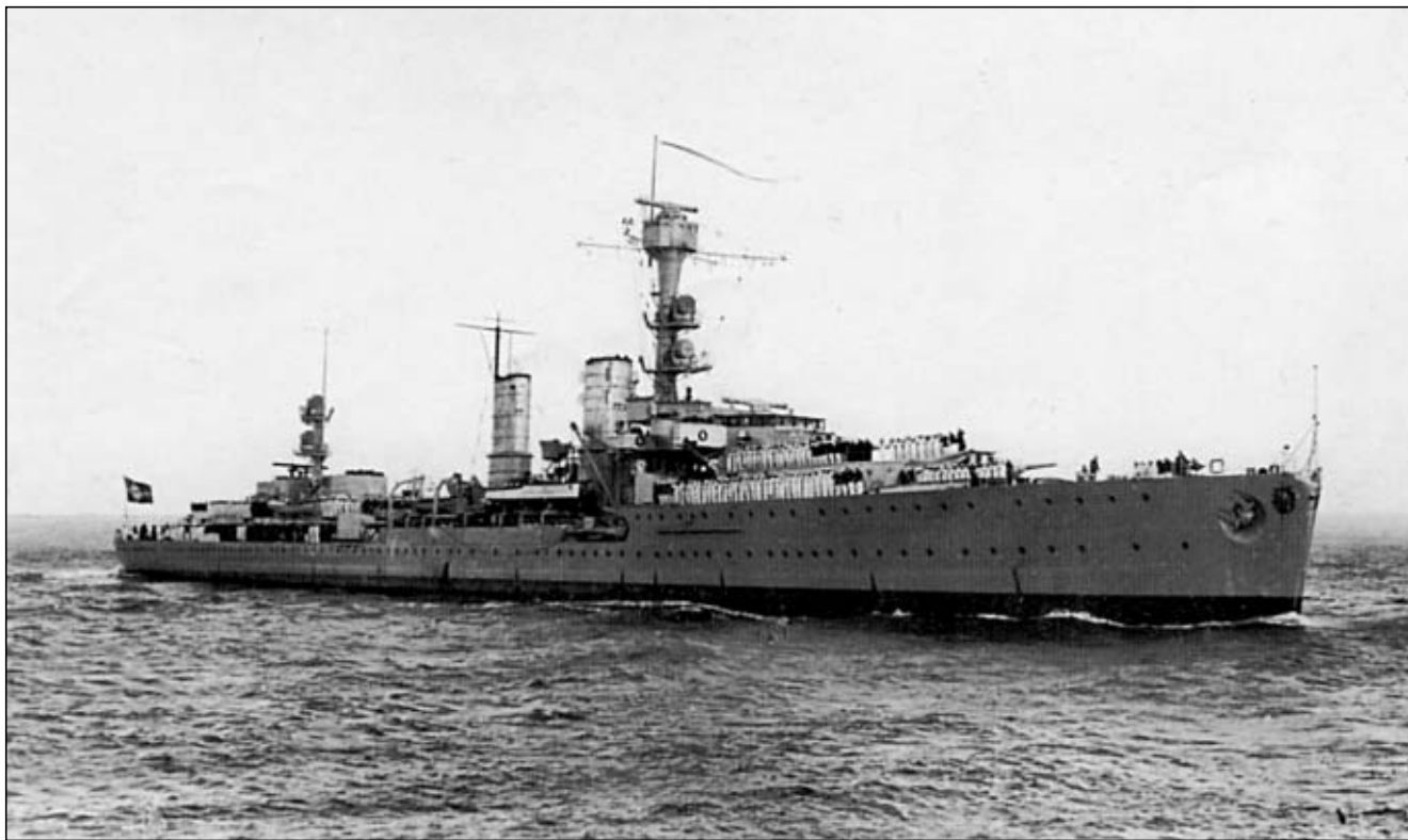
Emden w roku 1937 po drugiej przebudowie, w trakcie której zainstalowano na nim dodatkowy maszt (na tylnej krawędzi drugiego komina). Jego stengę można było teleskopowo opuszczać i podnosić, co zapewniało bezproblemowe przechodzenie pod mostami Kanału Kilonskiego. fot. zbiory Siegfried Breyer
