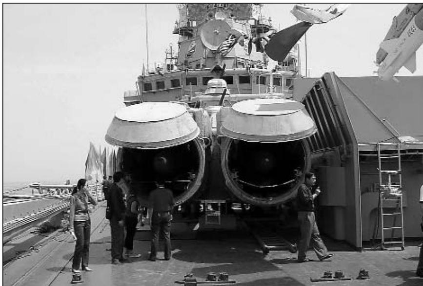
Cylindryczne wyrzutnie rakiet przeciwokrętowych systemu P-500 „Bazalt” (SS-N-12 „Sandbox”) na Minsk (już po sprzedaży okrętu do Chin). fot. zbiory Rafał Ciechanowski
