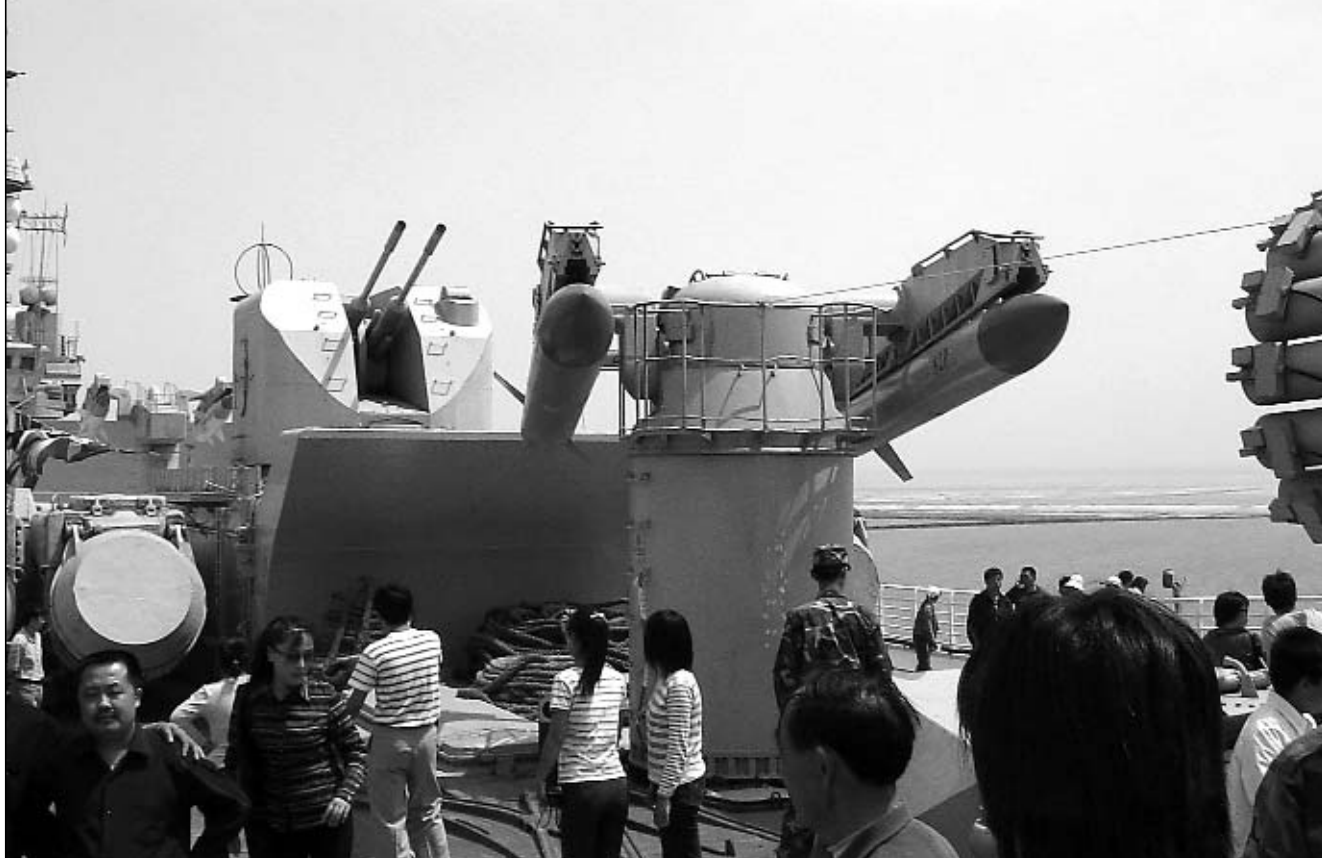
Na pokładzie Minska . Od lewej strony widoczne: działo uniwersalne AK-276 kal. 76,2 mm, wyrzutnia raketotorped systemu „Wichr” (SUW-N-1) oraz miotacz rakietowych bomb głębinowych RBU-6000. fot. zbiory Rafał Ciechanowski
