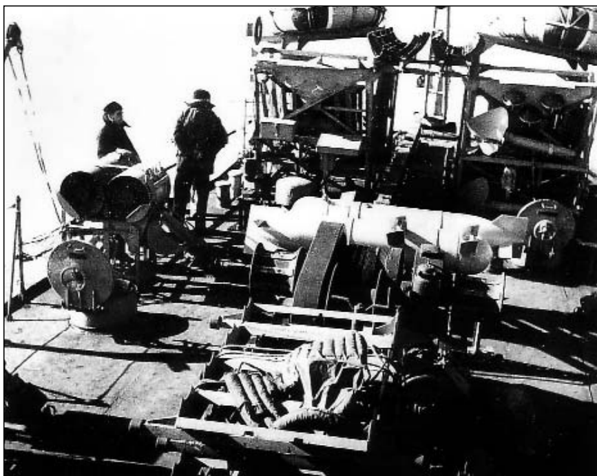
Wojenne ujęcie „przeciążonej” rufy korwety Driade . W środku widoczne „torpedino”, czyli torpeda ZOP, przed nią wielofunkcyjny podnośnik, na lewo bomby głębinowe i ich wyrzutnia, a z tyłu dwie zrzutnie bomb głębinowych typu „Gatteschi”, na wierzchu których znajdują się tratwy ratunkowe. Dla przewietrzenia znajdujących się pod pokładem pomieszczeń okrągłe luki zejściówek pozostawiono otwarte.
