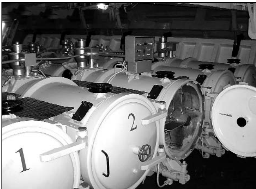
Pięciorurowa wyrzutnia torped PTA-53 kal. 533 mm.
