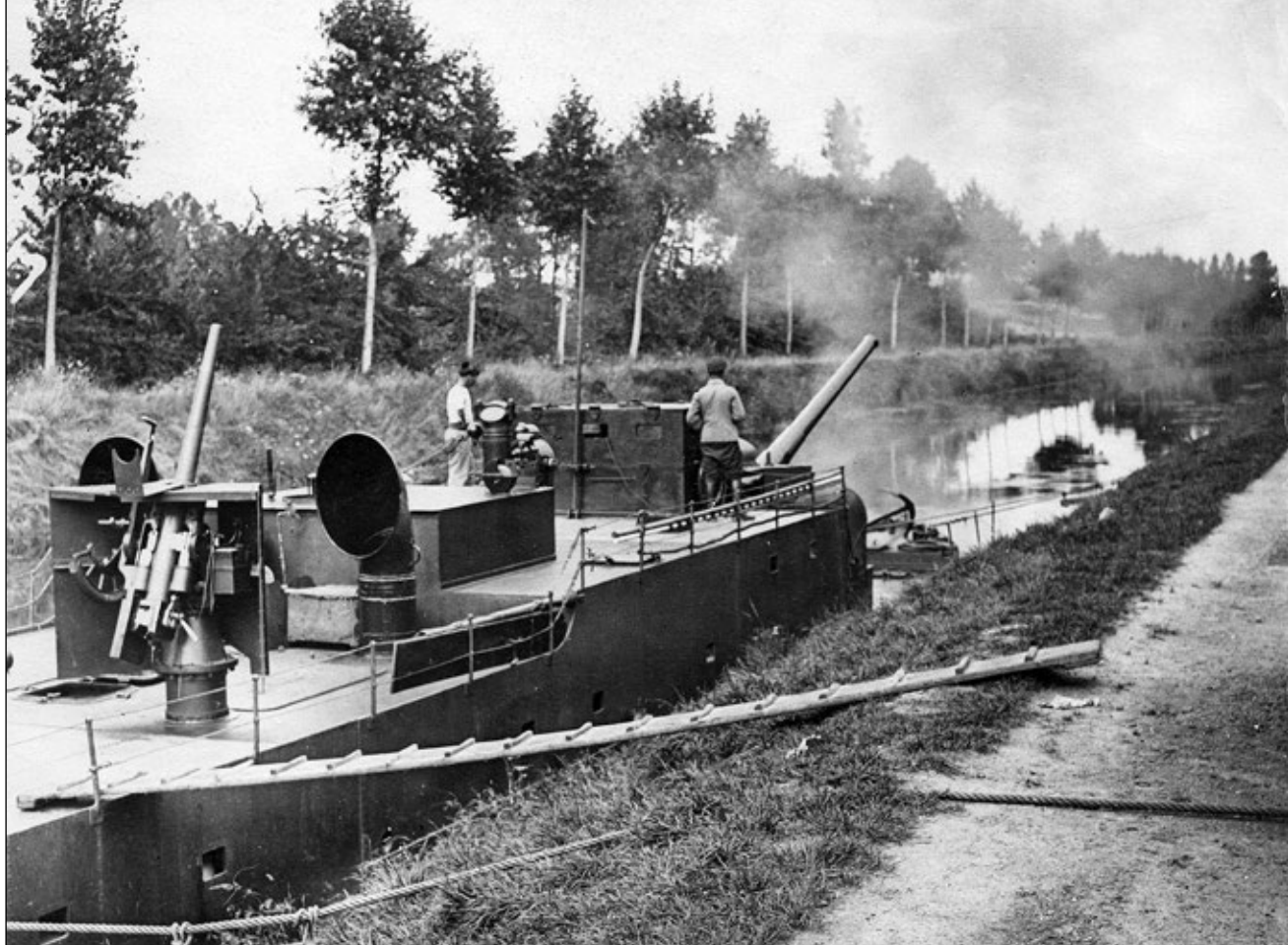
Kanonierka w czasie prowadzenia ognia. Obciążone liny pozwalają platformie na jak najszybsze odzyskanie stabilności. Dowódca i marynarz stoją na pomoście; artylerzyści chronieni są przez osłonę, reszta załogi ukrywa się wewnątrz kadłuba. Fot. zbiory Pierre-Françoisa Aujasa
