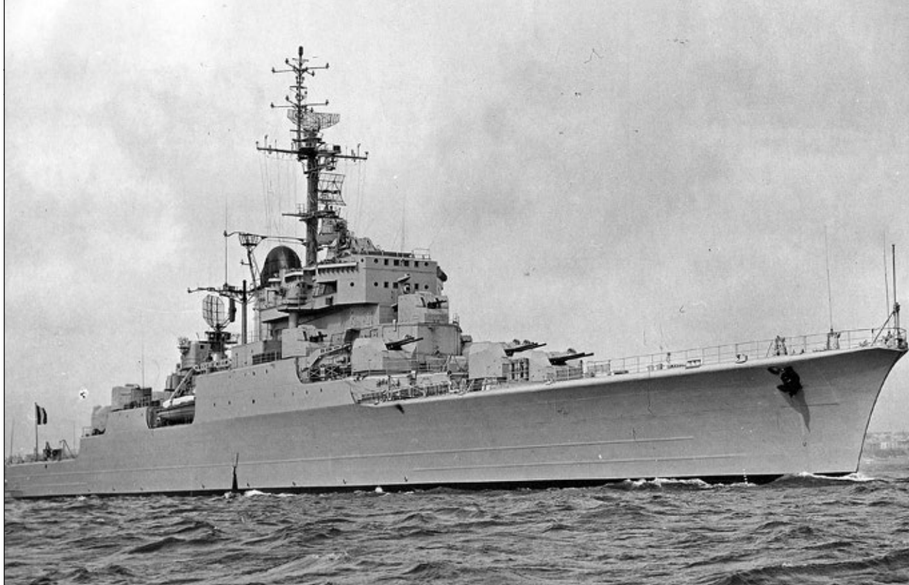
Fotografia De Grasse opuszczającego Tulon w 1962 roku po pierwszym remoncie kapitalnym. Pierwotnie zamontowany jego radar uniwersalny DRBV 11 został zastąpiony radarem DRBV 20A na dolnej platformie masztu przedniego. Zdemontowano także cztery stanowiska dział 57 mm mountings oraz dwa usytuowane na burtach dalec celowniki kontroli ognia artylerii głównej. Po obu stronach tylnej konstrukcji pomostu zabudowano nowe pokładówki. Fot. zbiory Landaisa, grzecznościowo Robert Dumas
