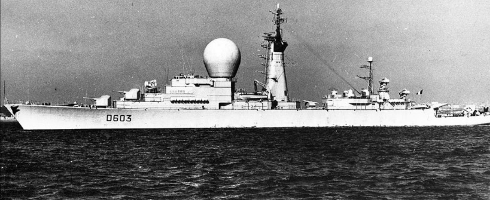
Tym razem Duquesne po wcieleniu do służby. Pod kutrem widoczne dwie okrągłe wyrzutnie torped.
