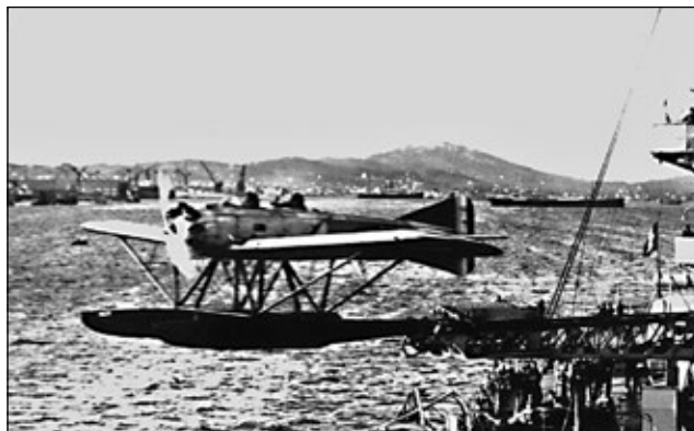
Wodosamolot Gourdou-Leseurre GL 813 podczas startu z katapulty krążownika Tourville . Fot. zbiory Gérarda Gariera
