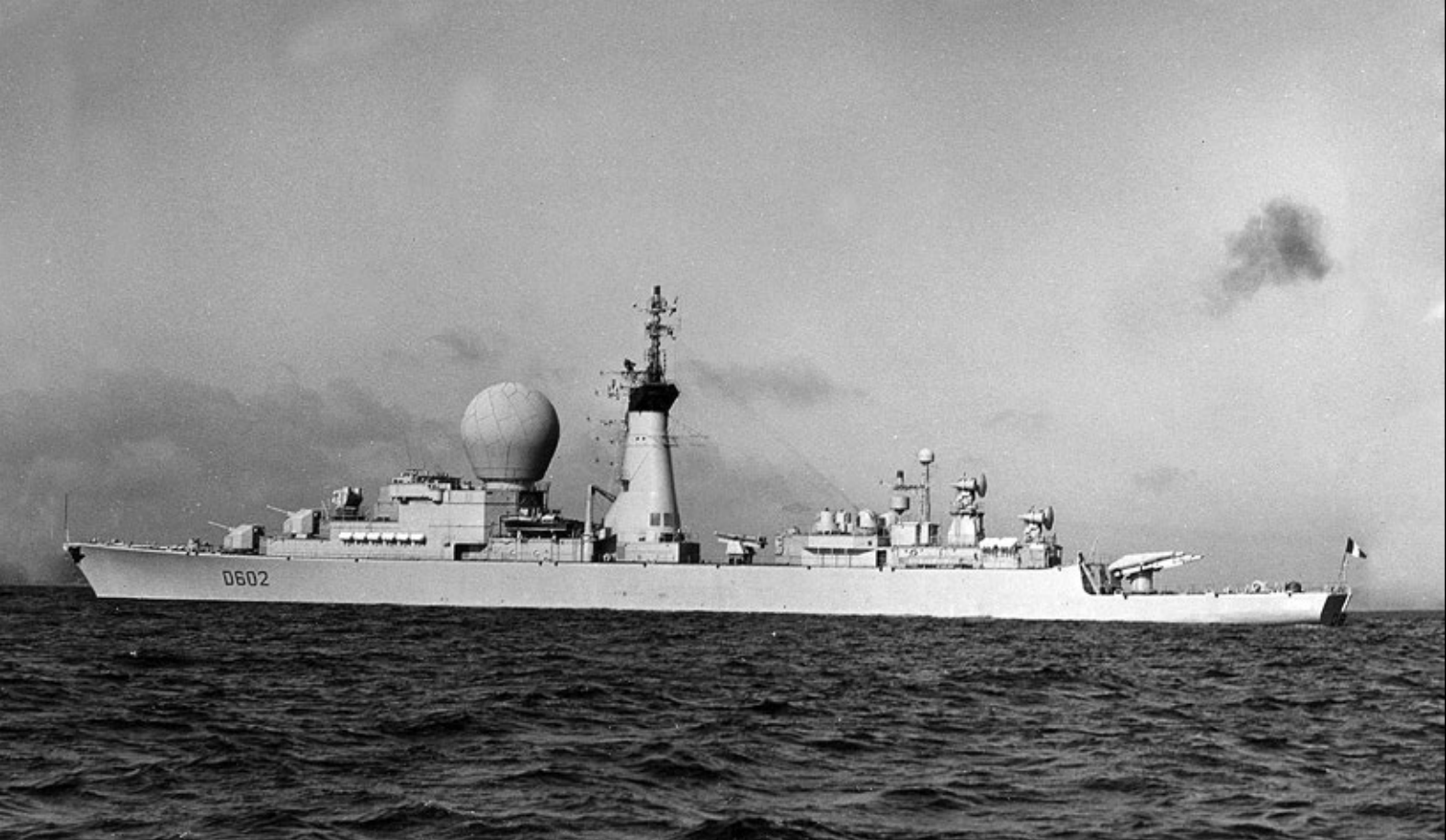
Suffren w eskadrze atlantyckiej. Za masztokominem wyrzutnia MALAFON, nadal brak sonaru holowanego.
