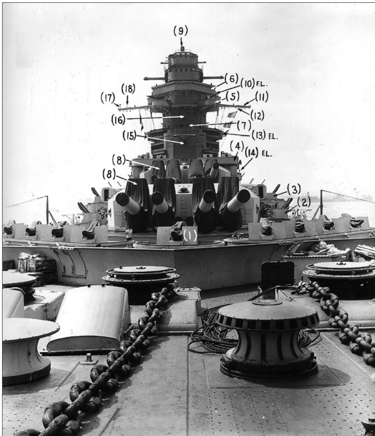
Richelieu po modernizacji w Stanach Zjednoczonych, 1943 rok. Widok z dziobu w kierunku pomostu bojowego. Na pierwszym planie kabestany, za falochronem bateria działek Oerlikon Mk 4 kal. 20 mm. Fot. zbiory Arthur D. Baker III
