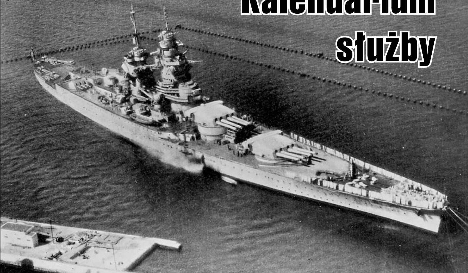
Pancernik Richelieu sfotografowany z lotu ptaka krótko po przybyciu do Dakaru. Widoczne pływaki dwóch zapór przeciwtorpedowych wokół okrętu. Fot. zbiory Jarosław Malinowski
