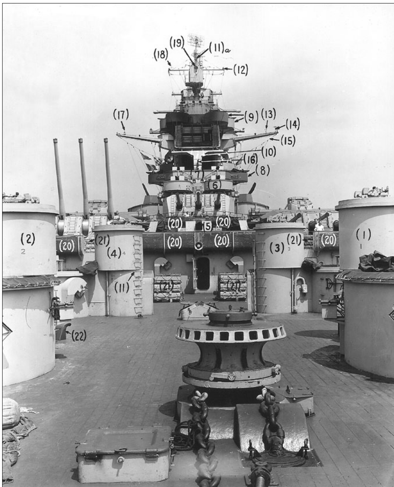
Kolejne ujęcie, tym razem z rufy w kierunku dziobu. W okrągłych stanowiskach widoczne dalocelowniki Mk 51, na pierwszym planie kabestan rufowej kotwicy.
