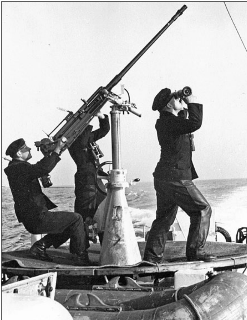
S 100 z widocznym dziobowym działkiem 20 mm na obrotowej lawecie Drehkranzlafette 41.
