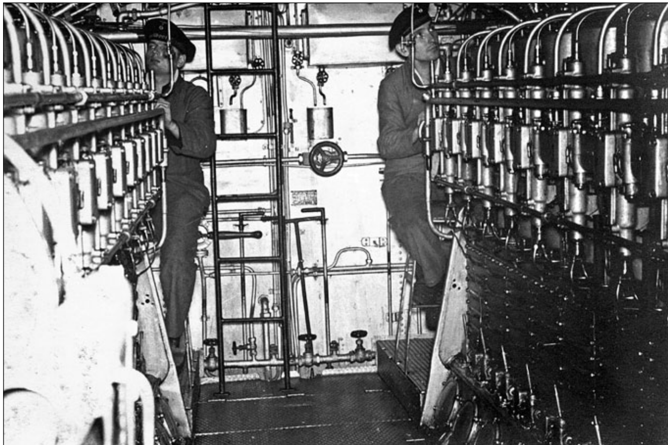
Przedział silnikowy na S 14. Widoczne silniki wysokoprężne MAN typu L 11 Zn19/30.
