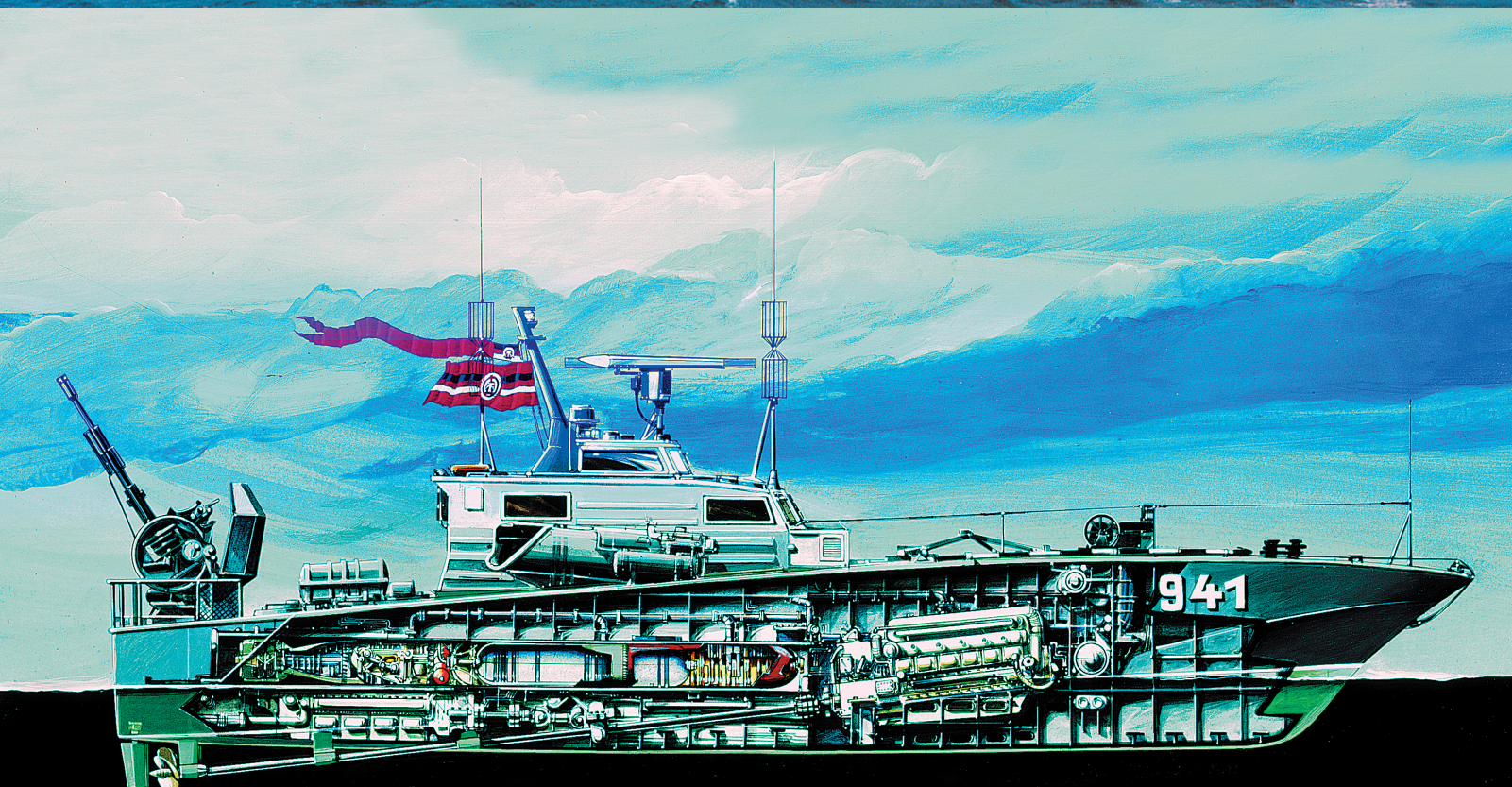
Przekrój wnętrza małego kutra torpedowego typu „Libelle” wschodnioniemieckiej Volksmarine. Rys. zbiory Hans Mehl
