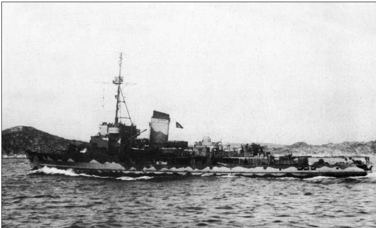
Trałowiec typu 40 u wybrzeży Norwegii. Uwagę zwraca antena radaru FuMB „Sumatra” na maszcie oraz ciekawy falisty kamuflaż.
