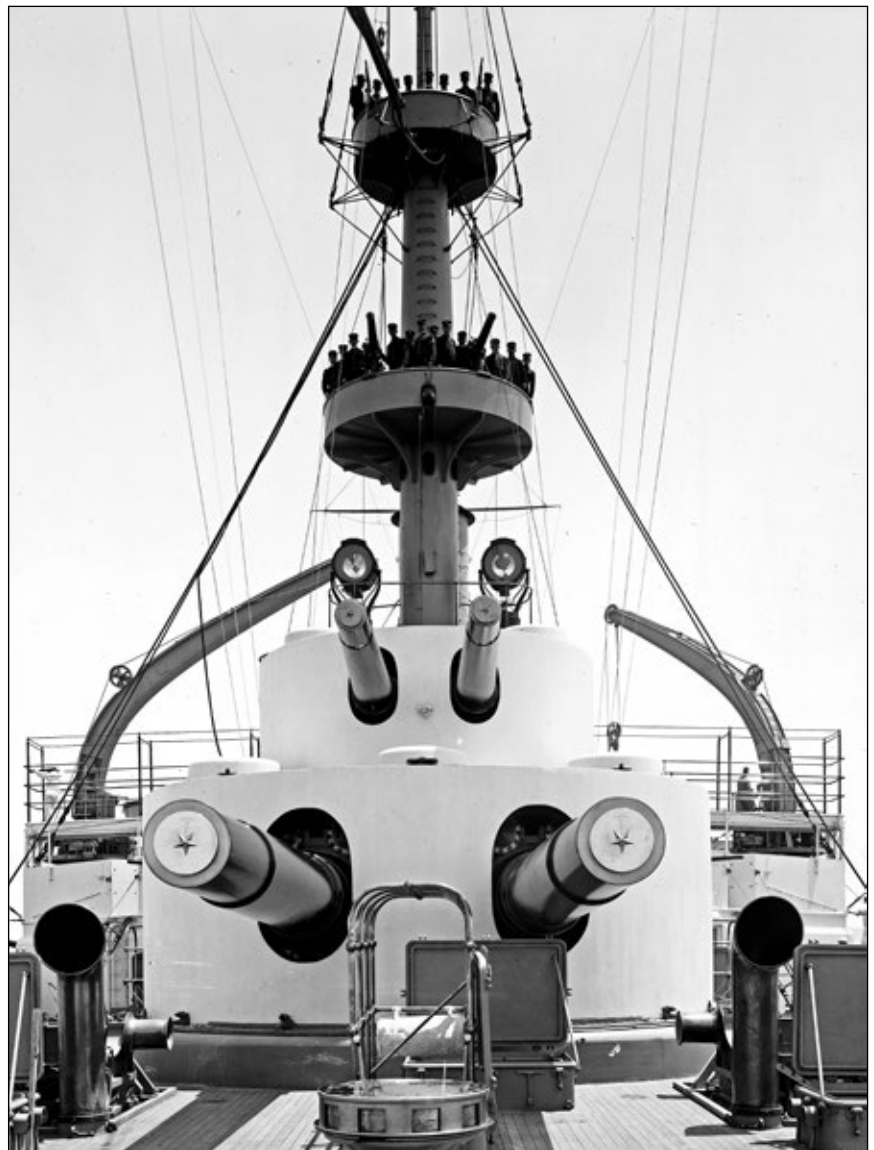
Rufowy zespół wież artylerii głównej i pośredniej pancernika Kentucky , za którym widoczny jest tylny maszt kolumnowy z dwoma marsami bojowymi. Fot. Library of Congress
