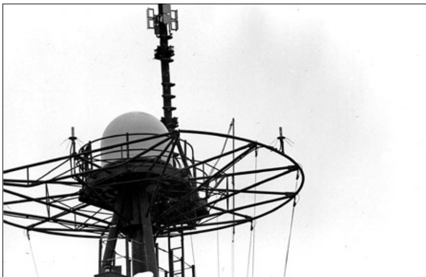
Anteny URN-60 systemu TACAN na topie masztu niszczyciela Rommel .
