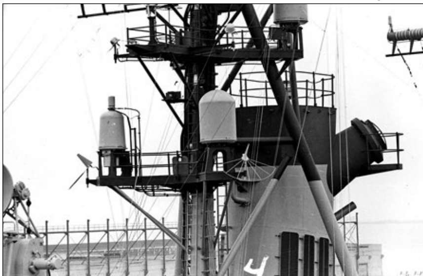
Anteny systemu WRE na przednim maszcie niszczyciela Rommel .
