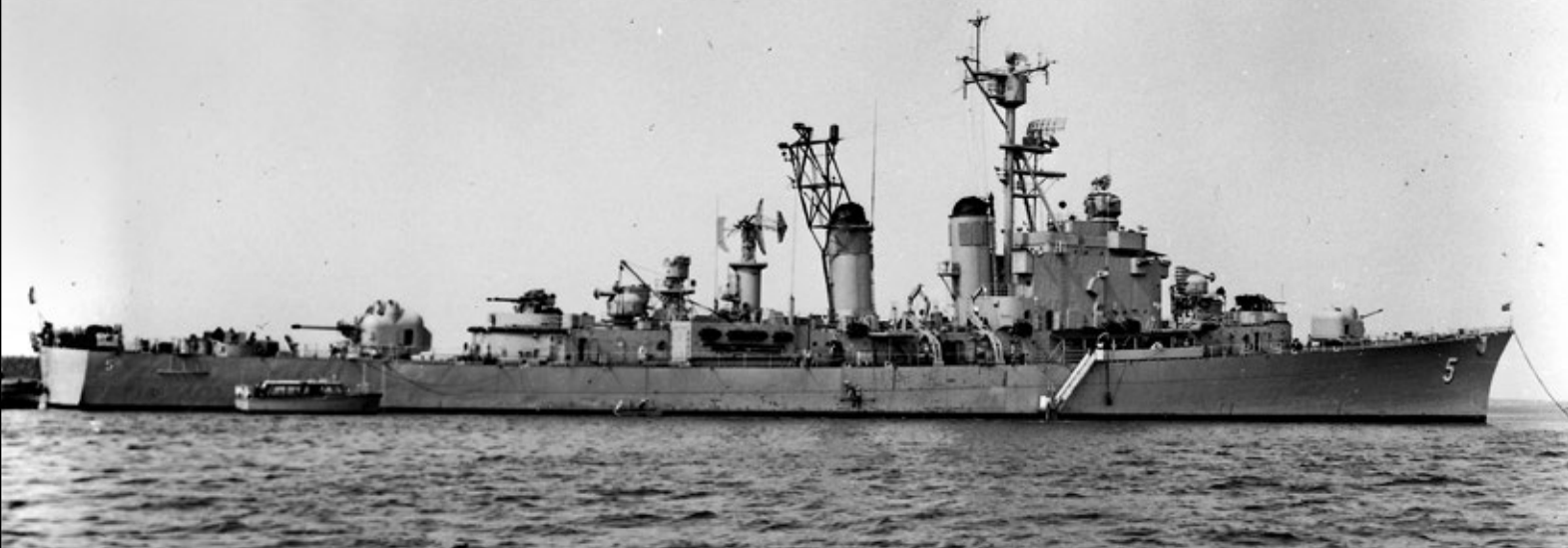
Fregata (przewodnik flotyli) Wilkinson (DL-5, eks DD 930) typu „Mitscher” w ujęciu z września 1955 r., pierwsze powojennej budowy amerykańskie jednostki w kategorii niszczycieli. Ich uzbrojenie obejmowało dwa działa kal. 127 mm i cztery kal. 76 mm, dwa miotacze ZOP Mk 108, sześć w.t. ZOP oraz dwa bezpilotowe DASH. Fot. zbiory Leo Van Ginderena
