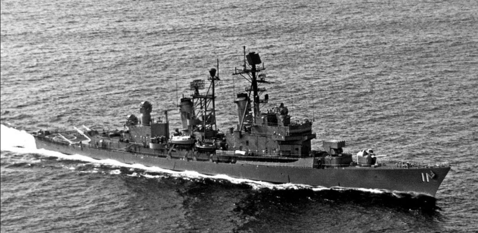
Mahan (DLG-11, następnie DDG-42) należał do typu „Farragut/Coontz”, pierwszych amerykańskich „fregat” (przewodników floty) rakietowych uzbrojonych w dwuprowadnicową wyrzutnię rakiet „Terrier”. Fot. zbiory Hartmuta Ehlersa
