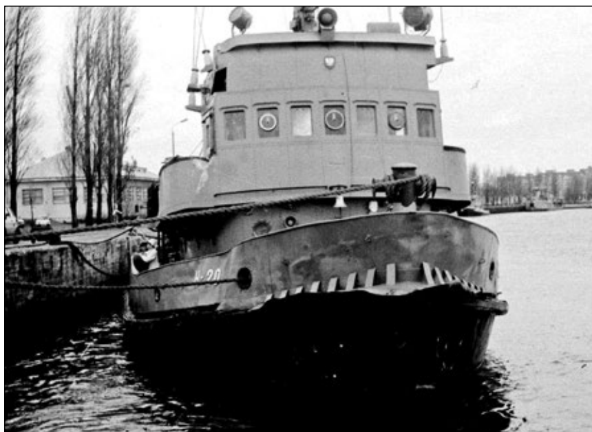
Dwa ujęcie holownika H-20 z uszkodzeniami dziobu i nadbudówki będących zapewne rezultatem otarcia o dziób innej jednostki. Wdzięczni będziemy czytelnikom za informację o tym incydencie. Fot. zbioru Mirosława Heberleja
