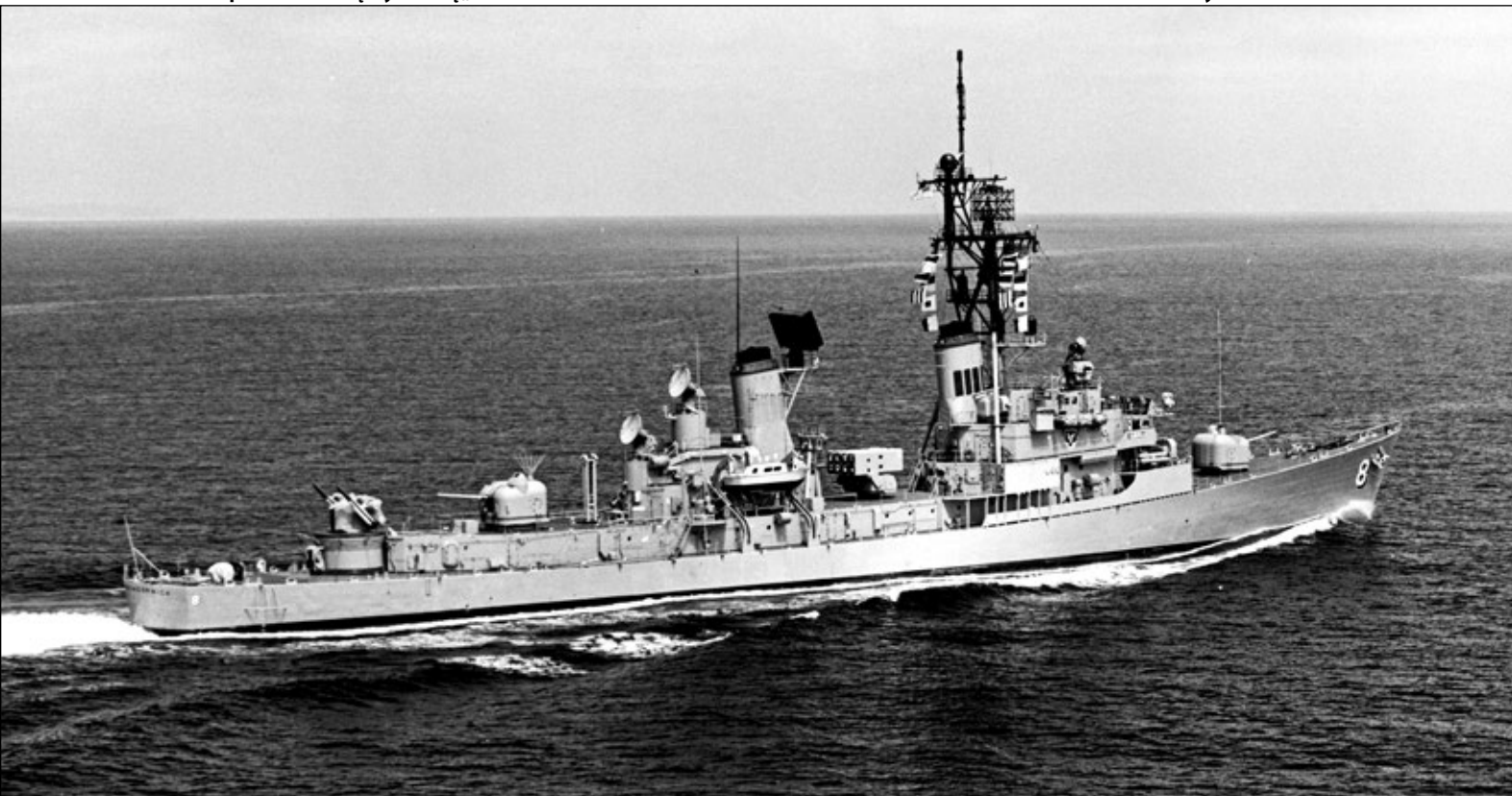
Lynde McCormick (DDG-8) był niszczycielem pierwszej wersji typu „Charles F. Adams”, będącej rozwinięciem typu „Forrest Sherman”. DDG-9 miał dwuprowadnicową wyrzutnię „Tartar” wraz z radarem SPS-39. Fot. zbiory Arthura D. Bakera III
