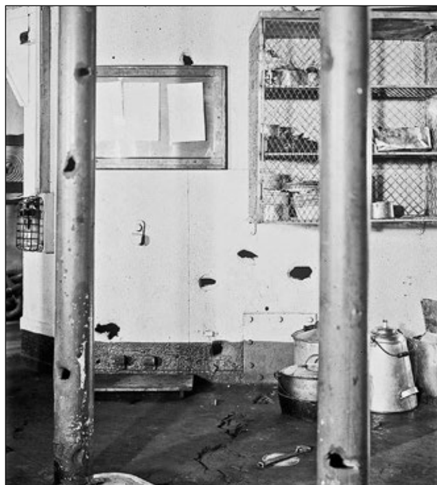
Uszkodzenia międzypokładu odniesione przez Iowę w bitwie koło Santiago 3 lipca 1898 roku.
