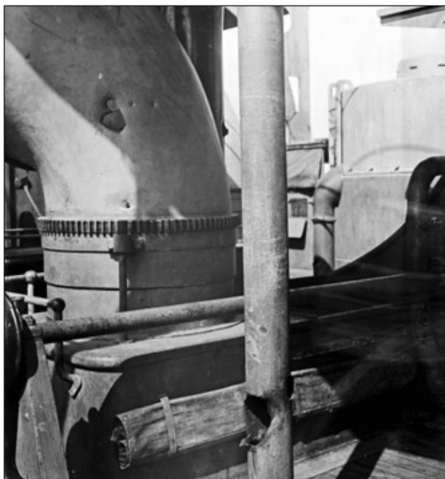
Jeden z nawiewników Iowy uszkodzony w bitwie koło Santiago 3 lipca 1898 roku odłamkami hiszpańskiej artylerii mniejszych kalibrów.
