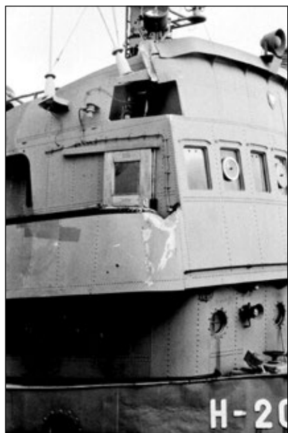
Dwa ujęcie holownika H-20 z uszkodzeniami dziobu i nadbudówki będących zapewne rezultatem otarcia o dziób innej jednostki. Wdzięczni będziemy czytelnikom za informację o tym incydencie. Fot. zbioru Mirosława Heberleja
