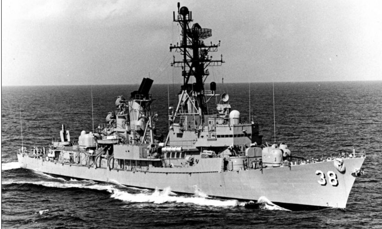
Jeszcze jeden obcy niszczyciel podczas prób z amerykańskim numerem: Perth (DDG-38) australijskiej floty. Trzy australijskie niszczyciele typu „Charles F. Adams” posiadały między kominami wyrzutni systemu „Ikara” zamiast ASROC, poza tym były bardzo zbliżone do swoich amerykańskich „pół-bliźniaków”. Fot. zbiory Arthura D. Bakera III
