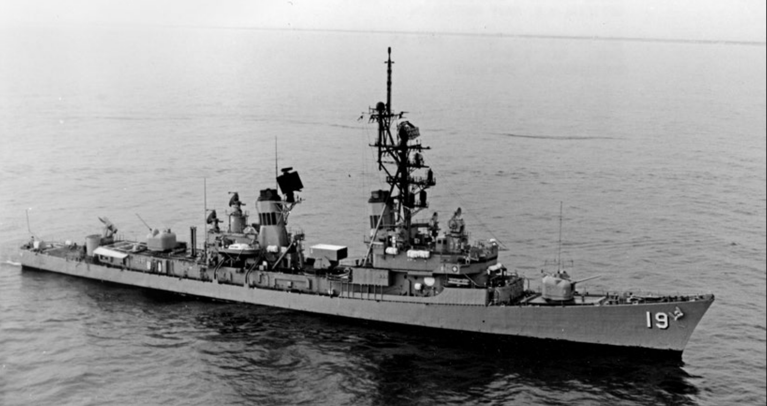
Tattnall (DDG-19) typu „Charles F. Adams” z radarem SPS-52 i pojedynczą wyrzutnią „Tartar” Mk 15.
