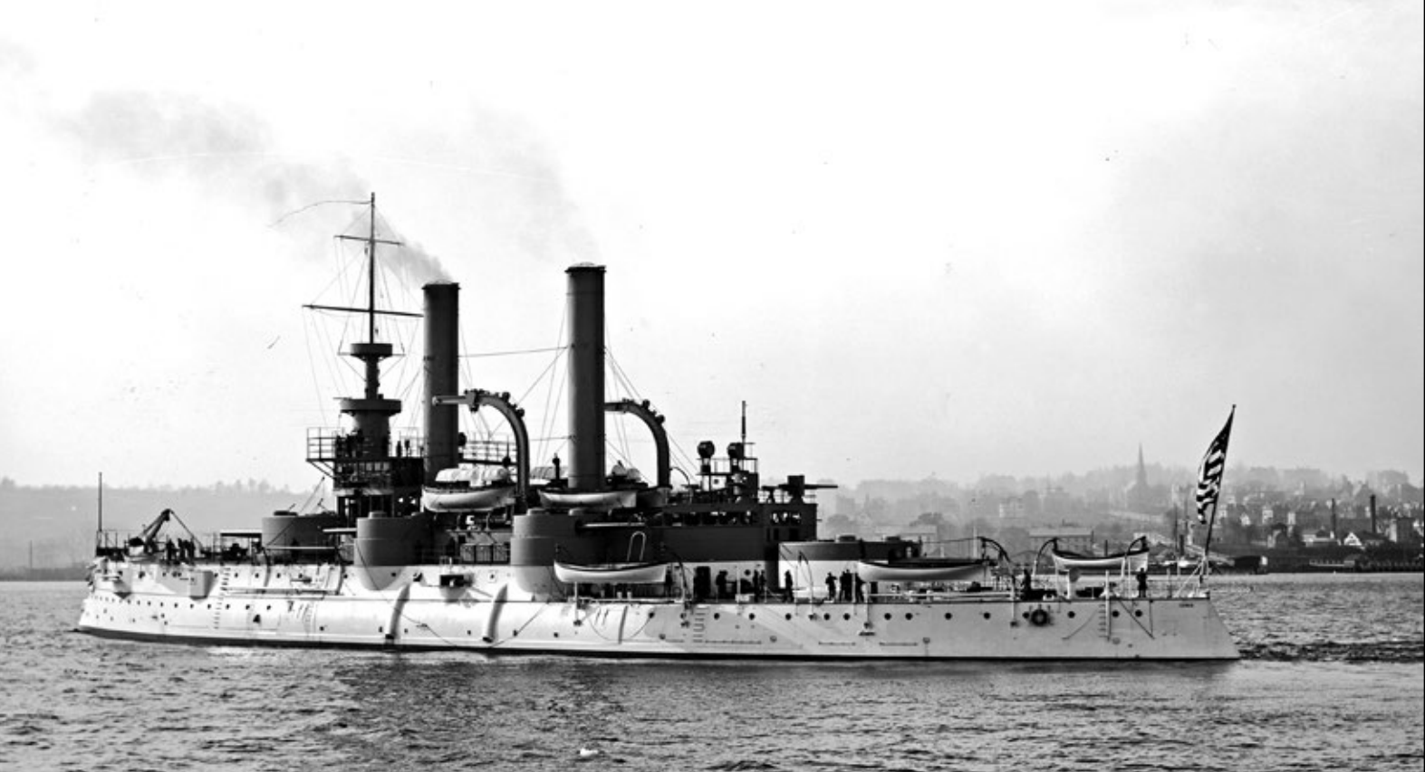
Na fotografii Iowa w ujęciu od rufy dobrze widoczne jest usytuowanie na poziomie pokładu górnego zarówno dziobowej wieży artylerii głównej kalibru 305 mm, jak i artylerii pośredniej kalibru 203 mm. Wieże tej ostatniej, inaczej niż na pancernikach typu „Indiana” zostały bardziej przybliżone do środka okrętu i rozsunięte na burty wsparte sponsonami. Fot. Library of Congress
