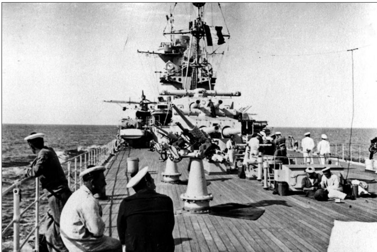
Fotografia pokładu rufowego Algérie wykonana we wrześniu 1939 roku. Na pierwszym planie: dwa prawoburtowe pojedyncze stanowiska dział kalibru 37 mm Mle 1925. Na wieży III widoczny dalmierz o dłuższej bazie 8-metrowej; który pod koniec lat 1930-tych zastąpił pierwotny model 5-metrowy. Fot. Alain Marchand, grzecznościowo Jean Moulin
