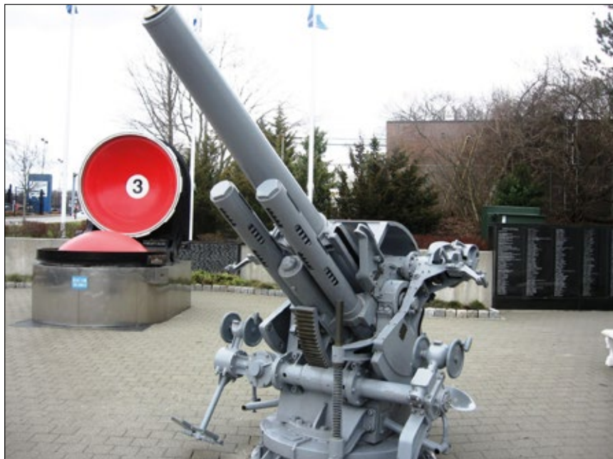
Będące głównym uzbrojeniem artyleryjskim amerykańskich okrętów podwodnych okresu II wojny światowej działo kalibru 127 mm L/25 Mk 17 na stanowisku Mk 40/0. Z tyłu pokrywa okrętowej wyrzutni rakietowych pocisków balistycznych. Fot. Jarosław Palasek
