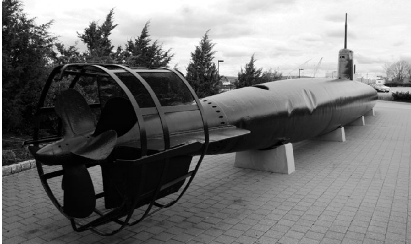
Miniaturowy, japoński okręt podwodny typu „A” od strony rufy. Widoczne przeciwbieżne śruby napędowe jednostki.
