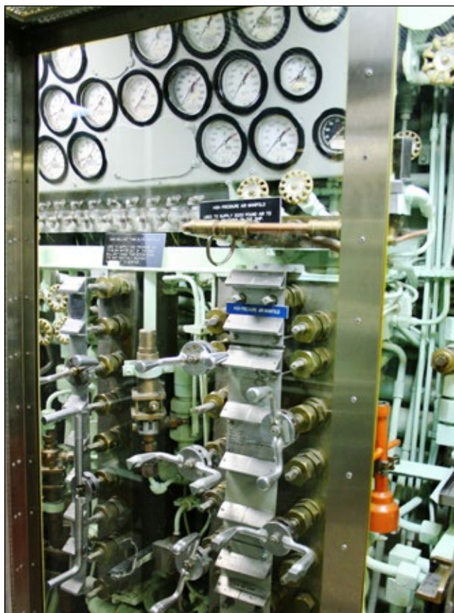
Manifold obsługi zaworów szasowania zbiorników balastowych okrętu. Fot. Jarosław Palasek
