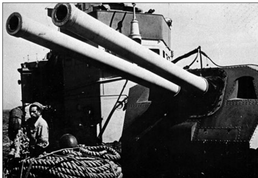
Dziobowa wieża dział kal. 120 mm L/50 na jednym z niszczycieli typu „Dardo”.
