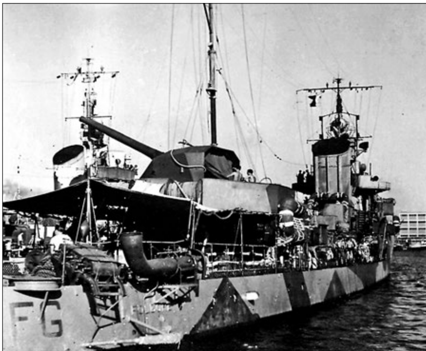
Folgore w Pireusie, 23 sierpnia 1942 r. Uwagę zwraca wylot chemicznego urządzenia dymotwórczego i zrzutnia bomb głębinowych.
