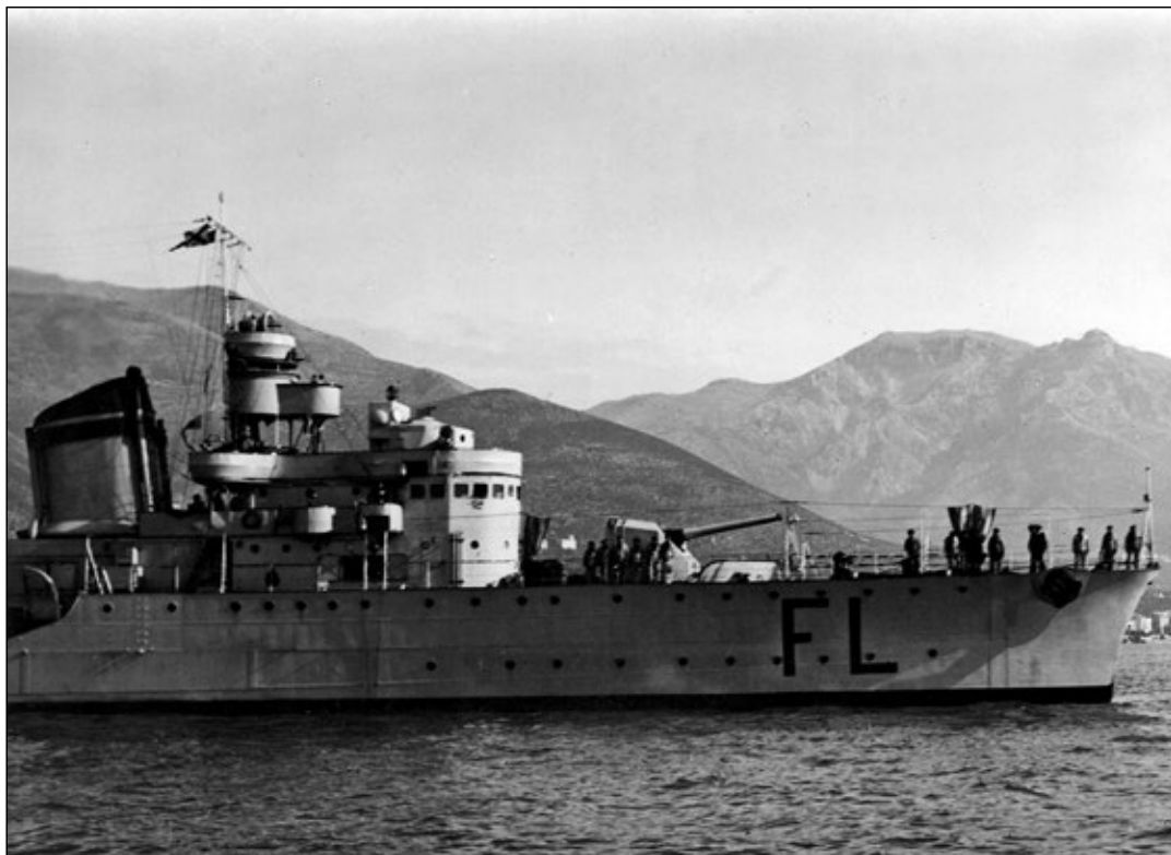
Dziób niszczyciela Fulmine . Na pomoście widoczne stanowisko dowodzenia i dalmierza.
