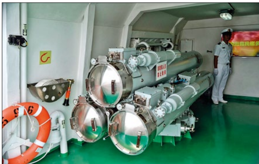
Trzyrurowa wyrzutnia torped ZOP kal. 324 mm
