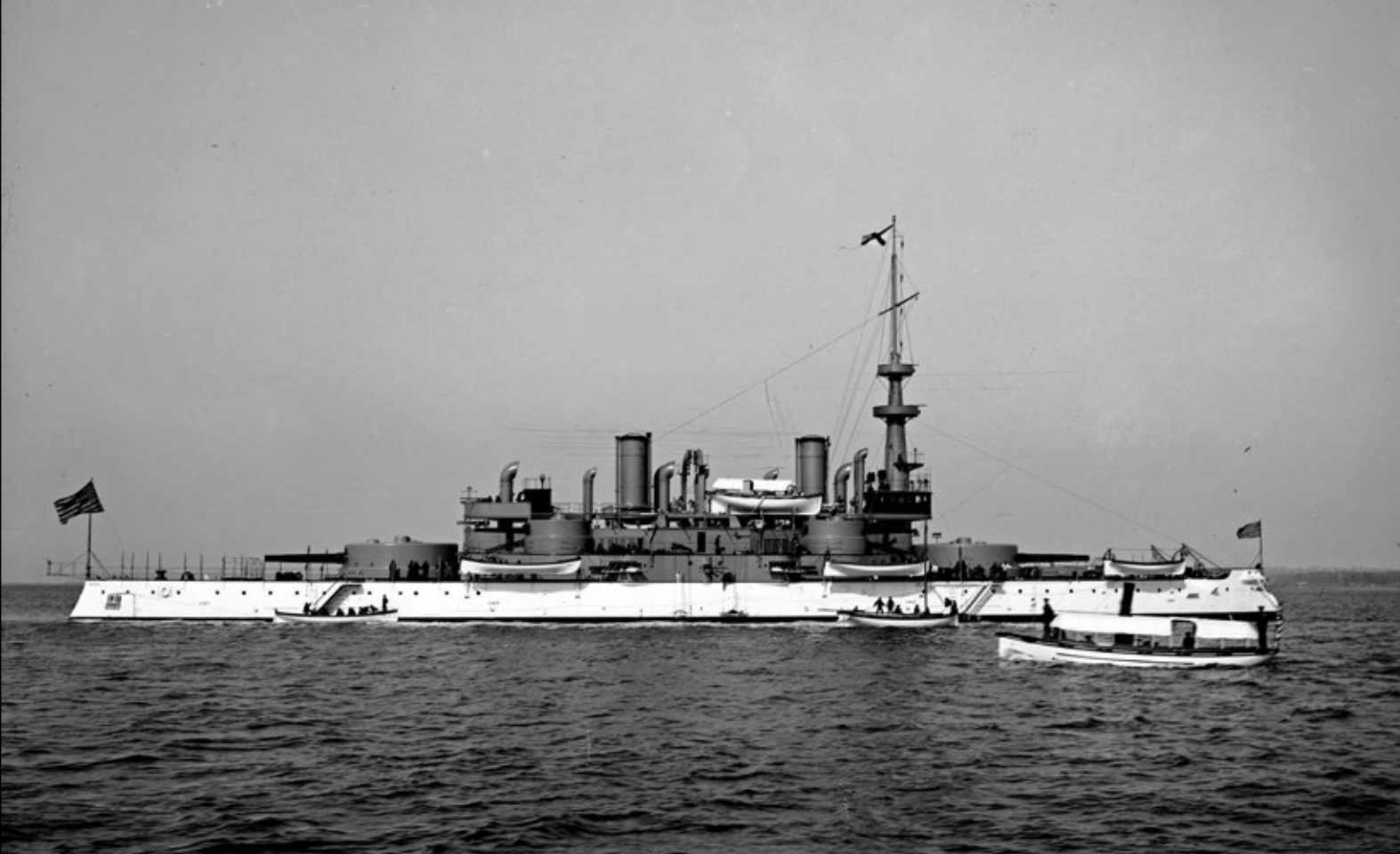
Wyróżnikami pancerników Indiana (na fotografii) i Massachusetts były min. duże, pojedyncze nawiewniki maszynowni nad owalnego kształtu rufowymi, rezerwowymi stanowiskami dowodzenia. Fot. U.S.Navy
