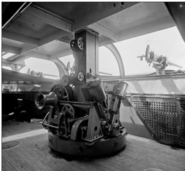
Fragment pokładu nadbudówki pancernika Massachusetts . W centralnej części widoczny mechanizm napędu dźwigu łodziowego, a na nadburciu działa 6-funtowa. Pod nimi złożone podesty umożliwiające ich obsługę. Fot. Library of Congress
