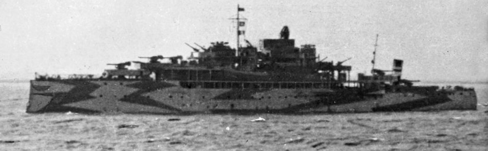
Niemiecka pływająca bateria przeciwlotnicza Undine (eks IJmuiden , eks Jacob van Heemskerck ) krótko po przebudowie w trakcie holowania do miejsca dyslokacji. Widoczny okrągły radar „Würzburg” kierowania ogniem na platformie śródkręcia. Fot. zbiory Reinharda Kramera
