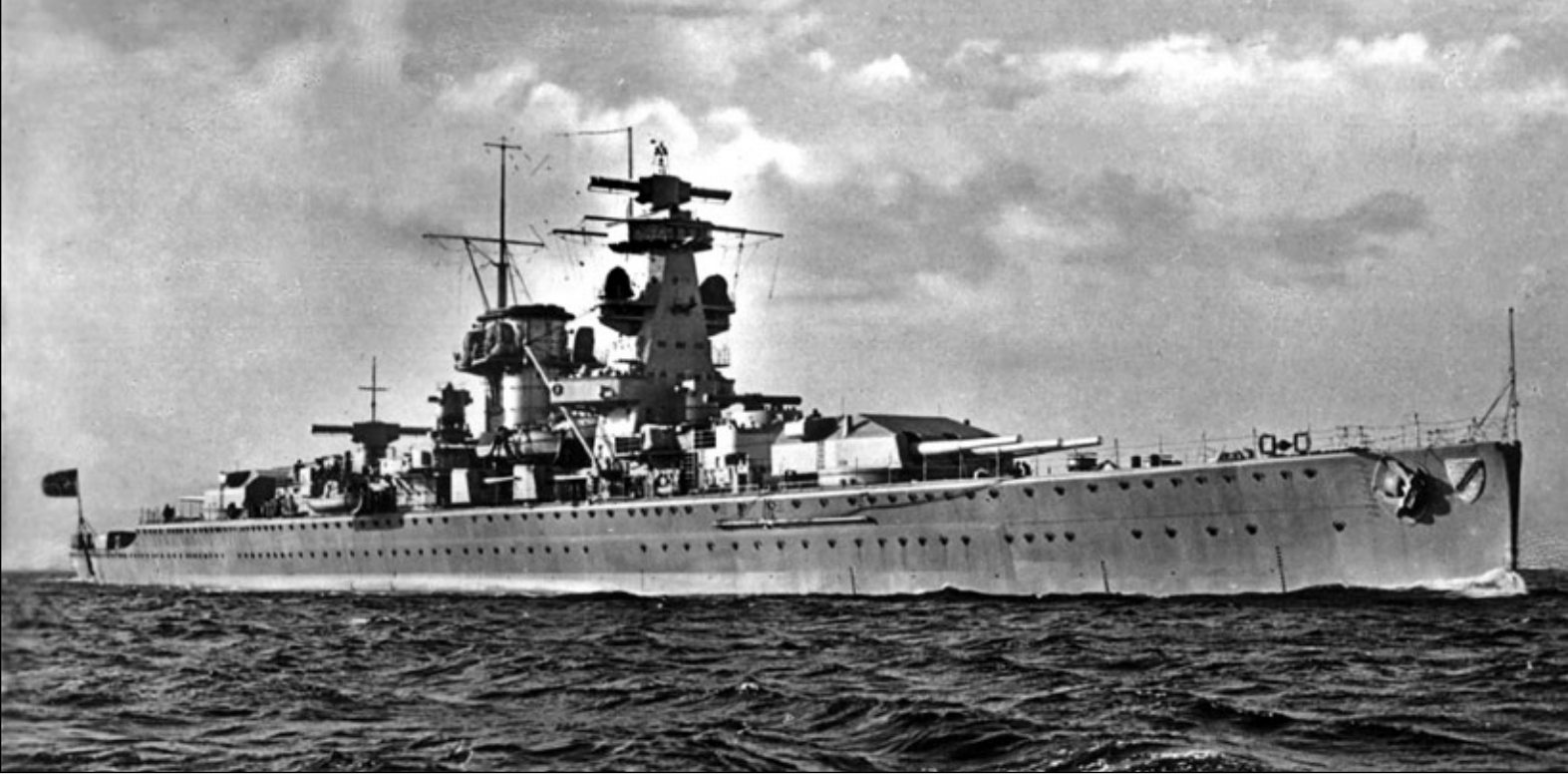
Admiral Scheer , druga jednostka opisywanego typu, różniła się kształtem pomostu bojowego.
