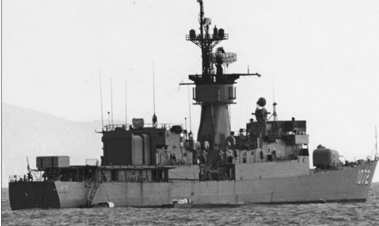
Blakely w okresie służby na Morzu Śródziemnym. Okręt posiada już wyrzutnię rakiet „Sea Sparrow” za lądowiskiem śmigłowca, na pawęży rufowej widoczne osłony sonaru holowanego. Fot. zbiory Hartmuta Ehlersa
