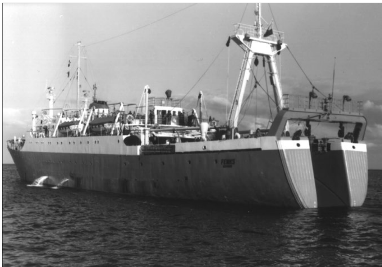
Feniks , również z IV serii produkcyjnej. Widoczny odmienny kształt rufowego masztu i mostka niż na jednostkach II serii.
