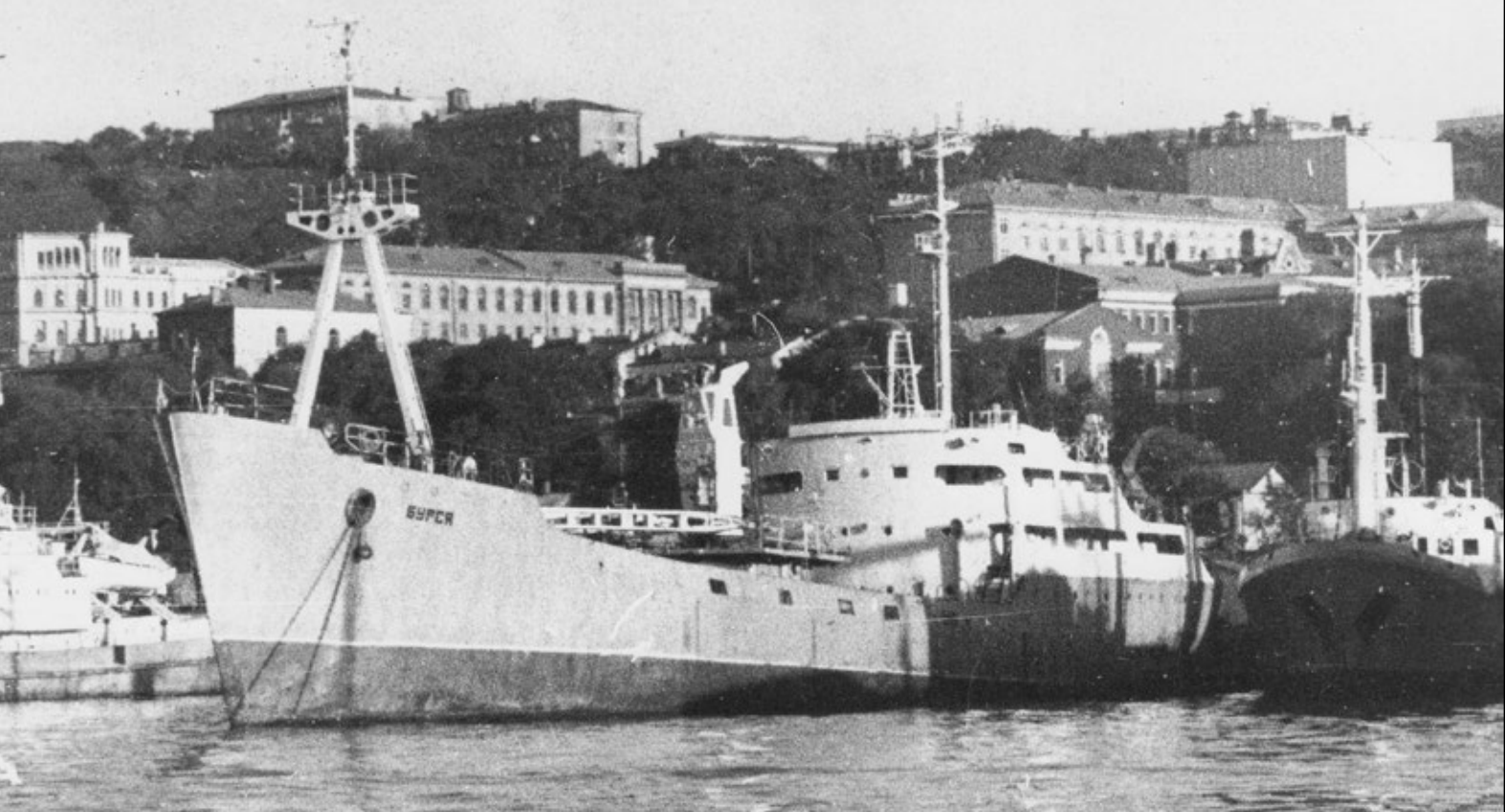
Bureja w Władywostoku, wrzesień 1989 roku. Uwagę zwraca nowy dźwig 10-tonowy na śródokręciu.
