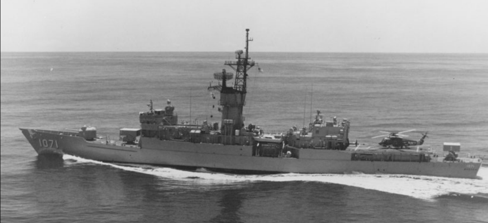
Badger w lipcu 1984 roku. Widoczne wszystkie modyfikacje z tego okresu (podwyższony dziub, listwa kadłuba), wyposażenie elektroniczne, itp., na lądowisku śmigłowiec Kaman „Seasprite”. Fot. zbiory Hartmuta Ehlersa
