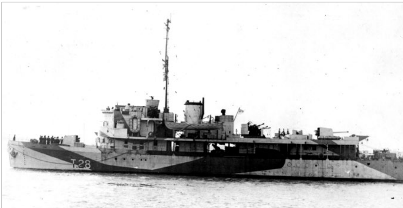
Locust w lutym 1943 roku. Widoczne stanowisko karabinów kalibru 7,7 mm na skrzydle pomostu, osłonięte stanowisko karabinów kalibru 12,7 mm tuż pod dalmierzem, poczwórny „pom-pom” za kominem, awaryjne, potrójne koło sterowe za nim, pojedynczy Oerlikon kalibru 20 mm na pokładzie oraz wyrzutnie bomb głębinowych i pojedynczy Oerlikon kalibru 20 mm na rufie. Osłony przeciwko pociskom karabinowym zostały zdemontowane z okolic dział 102 mm oraz pokładu – pozostawiono je jednak na pomostach dolnym i górnym. Fot. Imperial War Museum
