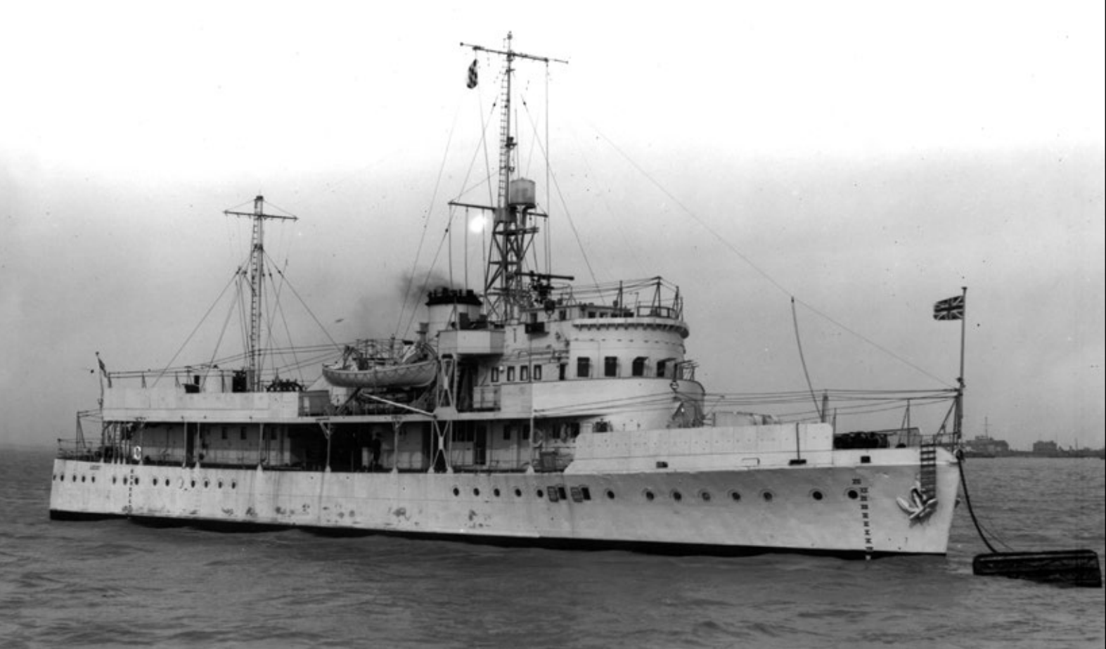
Locust w marcu 1946 roku po przebudowie przystosowującej do służby na Dalekim Wschodzie. Poczwońny „pom-pom” zastąpił rufowe działo kalibru 102 mm. Ciągłe są pozostawione składane osłony przeciwko pociskom karabinowym na pomostach dolnym i górnym, a pozostałe osłony zostały wyremontowane. Linia owalnych ambratur stanowisk karabinów Lewisa jest widoczna w obłachowaniu osłon (na lewo od potrójnego koła sterowego), a kolejne dwie ambratury widoczne są na obłachowaniu skrzydeł pomostu. Większość takielunku jednostki stanowi takielunek tentów. Marki zanurzeniowe wskazują, że Locust miał wówczas zanurzenie około 7 stóp, tj. 2,13 m. Fot. Imperial War Museum
