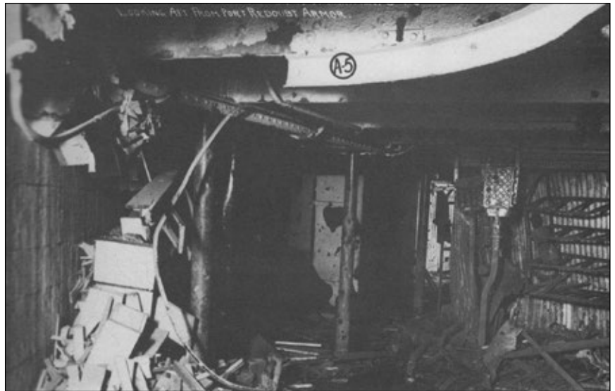
Wnętrze San Marcos podczas pierwszej inspekcji uszkodzeń w dniu 20 marca 1911 roku. Fotografia wykonana w pomieszczeniu położonym na lewej burcie jednostki tuż za redutą pancerną obrazuje efekt wybuchu pocisku burzącego kalibru 305 mm.
