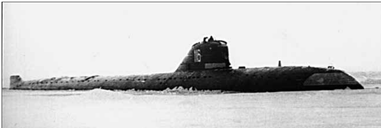
K-42 w trakcie rejsu arktycznego i przebazowania na Daleki Wschód w sierpniu 1968 roku. Ta fotografia doskonale ukazuje dielektryczne osłony zamontowane w kadłubie i kiosku.
