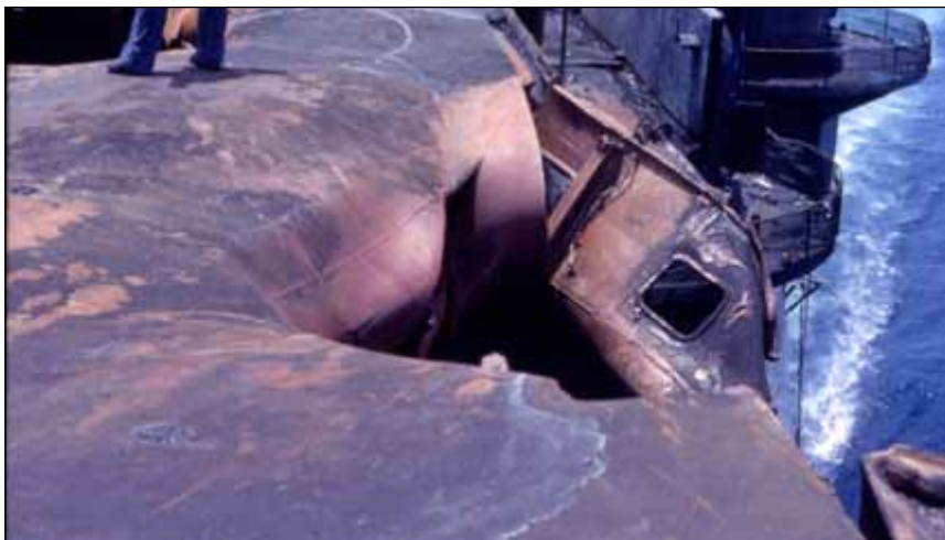
Zniszczenia pokładu lotniczego Forrestal skutkiem eksplozji bomb podczas pożaru w dniu 29 lipca 1967 roku. Fot. U.S. Navy
