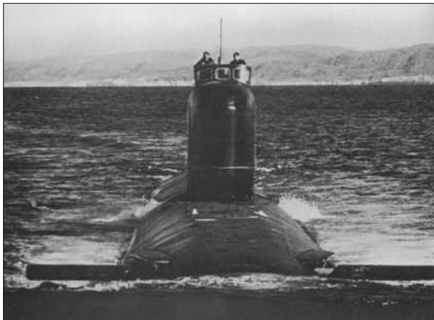
Leninskij Komsomoł - widok od dziobu z rozłożonymi sterami głębokości. Na wąskim kiosku widać rozkładaną osłonę przeciwwiatrową. Fot. zbiory Jarosław Malinowski
