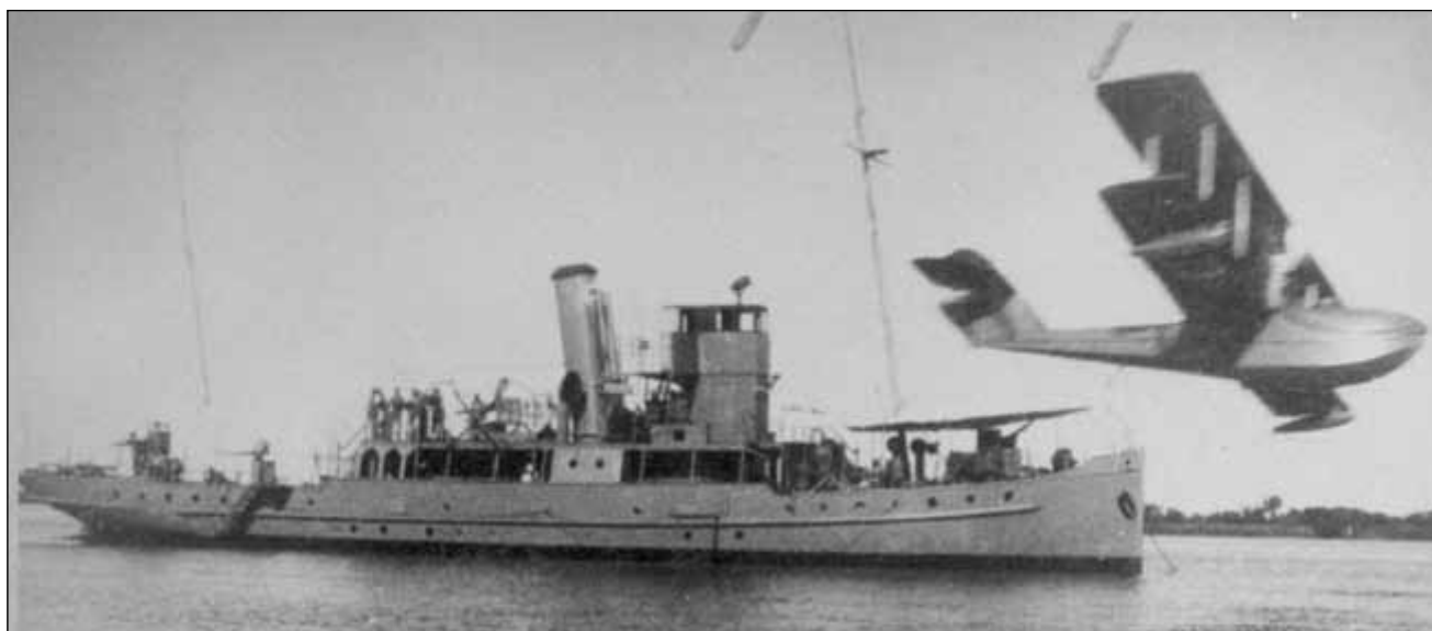
Kanonierka Tacuarí eks- Adolfo Riquelme podczas wojny o Chaco w roku 1933 na kotwicy koło Bahía Negra. Jego uzbrojenie składa się z dwóch armat kal. 76 mm na dziobie i rufie oraz dwóch kal. 37 mm na pokładzie nadbudówki za kominem. W niskim locie widoczna łódź latająca R.1 typu Savoia-Marchetti S.59bis. Fot. zbiory Hartmut Ehlers
