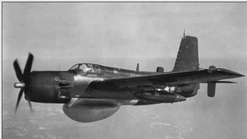
Samolot AE-2W „Guardian” przeznaczony do wykrywania i zwalczania okrętów podwodnych. Pod kadłubem widoczna osłona anteny radaru. Fot. zbiory Seweryn Fleischer
