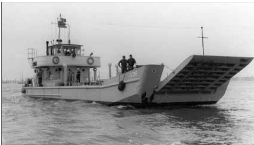
LCM 237 podchodząca do Punktu Załadunku desantu. Włączony mechanizm napędowy rampy załadowczej. Fot. zbiory Hartmut Ehlers
