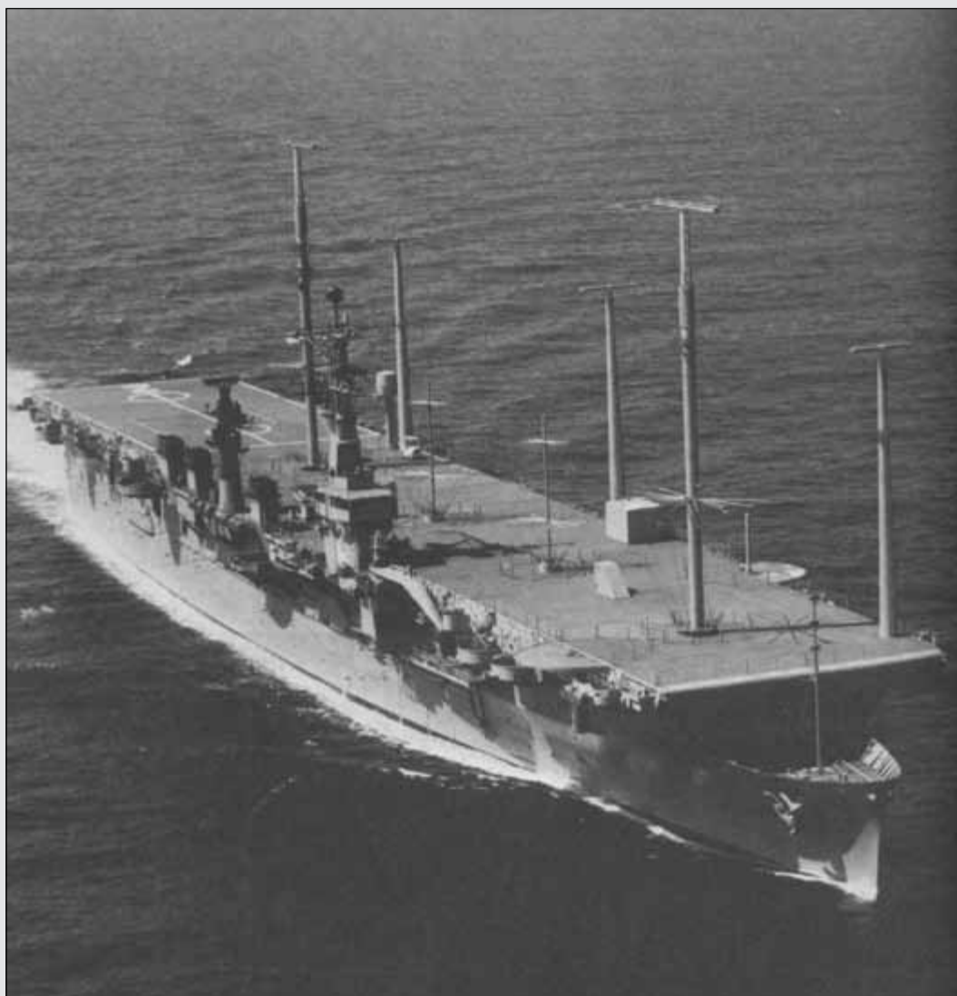
Wright w końcowej konfiguracji pływającego narodowego rezerwowego stanowiska dowodzenia o sygnaturze „CC-2”. Fot. via Norma Friedman
