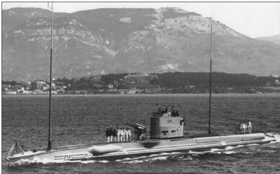
Jednymi z najstarszych okrętów podwodnych II klasy, jakimi dysponowała Marine Nationale w 1939 r. były jednostki typu Circé (na fotografii). Seria tych okrętów nie była zbyt liczna – liczyła tylko 4 jednostki. Okręty tego typu nie były wolne ale za to dość silnie uzbrojone w broń torpedową. Fot. Marius Bar
