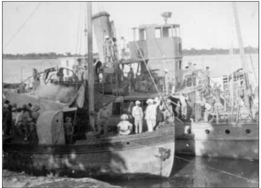
Kanonierka Tacuarí eks- Adolfo Riquelme pod koniec wojny o Chaco z lichtugą (hiszp. „chata,” = płaskonosowa,) Río Teucu w rejonie walk. Poniżej nieco wysunięte do przodu widoczne są dodatkowe karabiny maszynowe zainstalowane w lawetach lotniczych oraz jedno z dwóch dodatkowych działek kal. 37 mm typu Maxim ustawione na prawoburtowej strony dachu nadbudówki.
