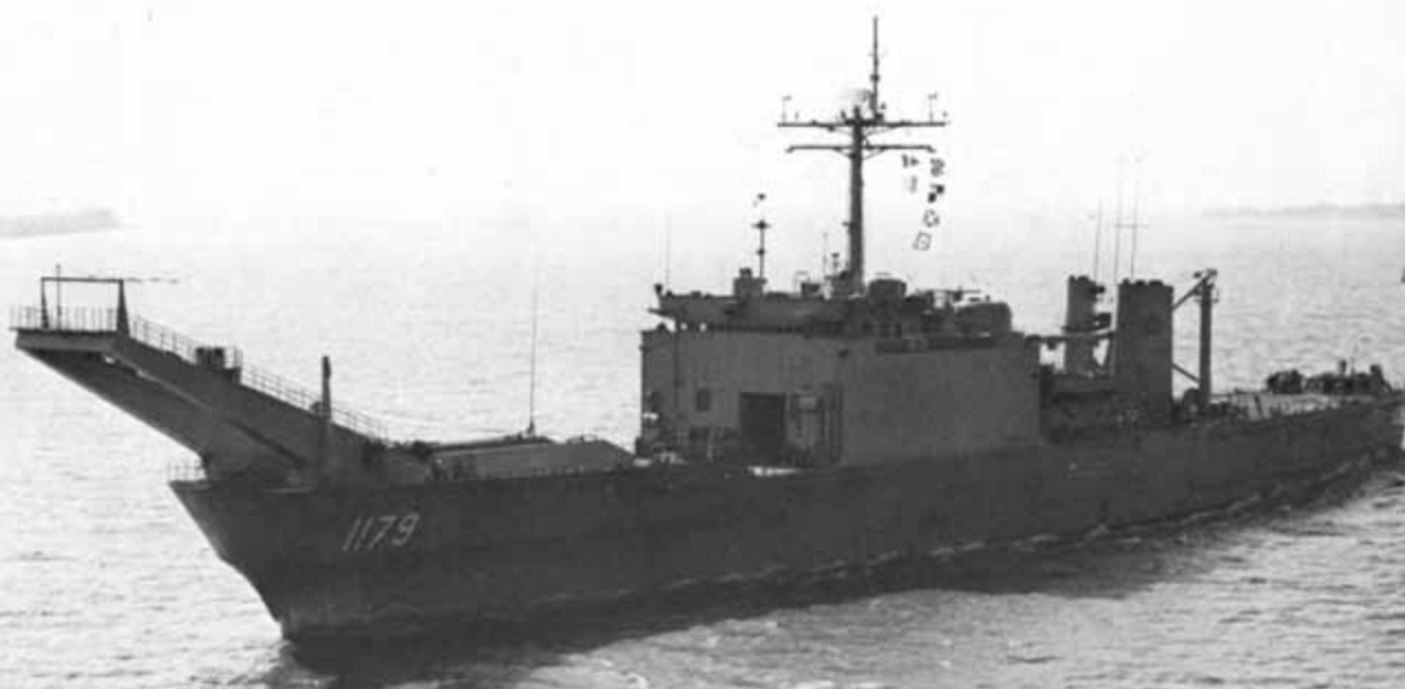
Amerykański okręt desantowy Newport (LST 1179) krótko po wcieleniu do służby w sierpniu 1969 r. Był on prototypem liczącego 20 jednostek typu, przeznaczonego do transportu ciężkiego sprzętu pancernego. Fot. U.S. Navy via „Warship International”
